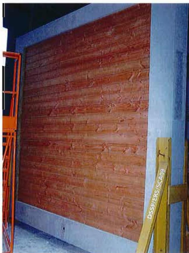
**Vue d'ensemble des lattes de bardage montées**
