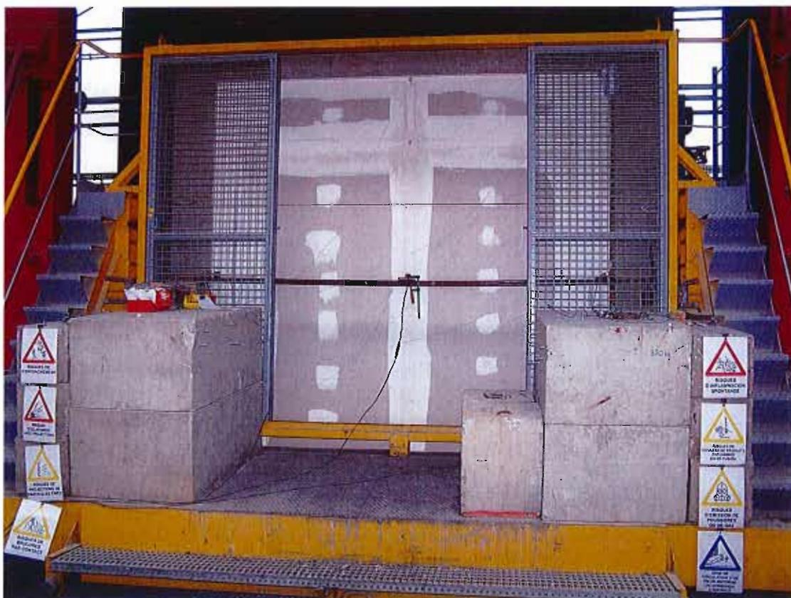
**Face non-exposée de l'élément à 20 minutes d'essai**
