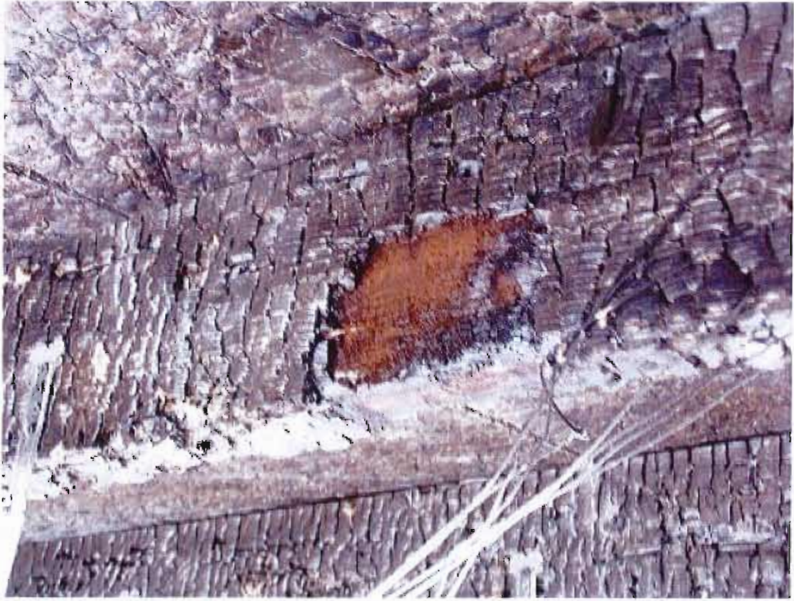
Vue de détail de la carbonisation d'une solive vers les extrémités après la réalisation de l'essai
