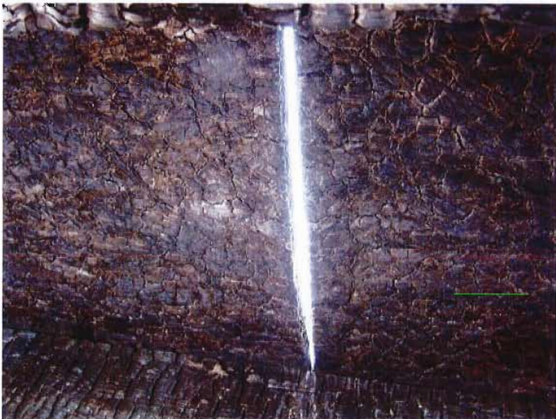
Vue de détail de la face exposée du revêtement de sol de type OSB
