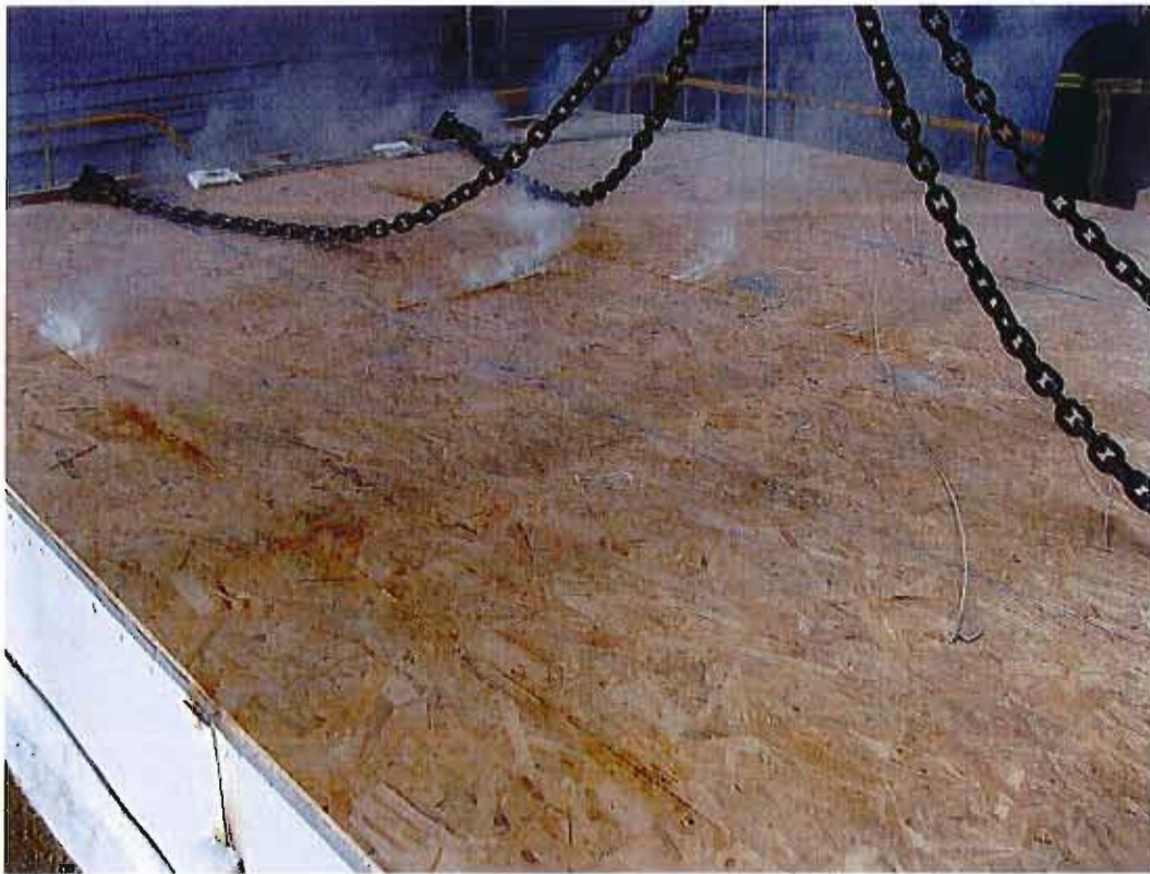
Vue de détail de la face non exposée au niveau du joint transversal SUD à 39 [min.]
