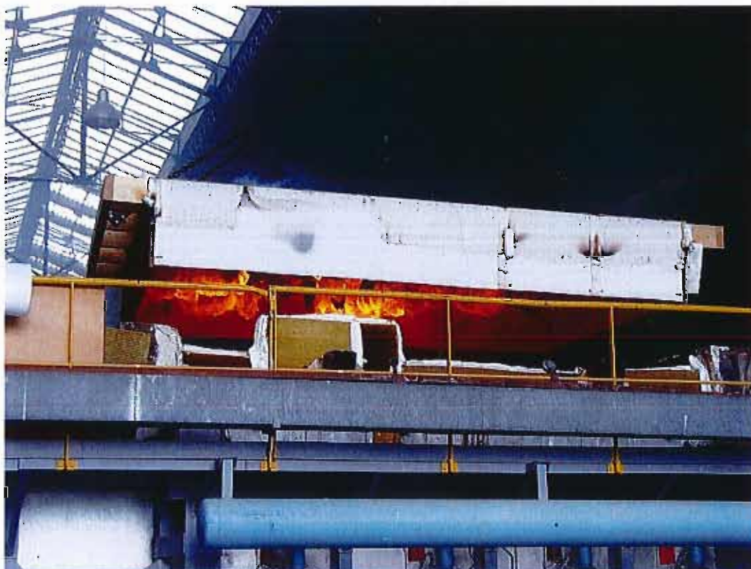
Vue de la face exposée à l'arrêt de l'essai et retrait de l'éprouvette du four
