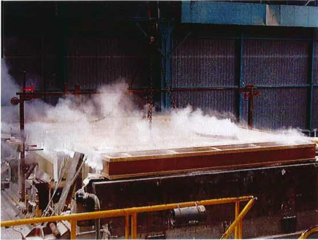
Vue de la face non exposée à 20 minutes d'essai
