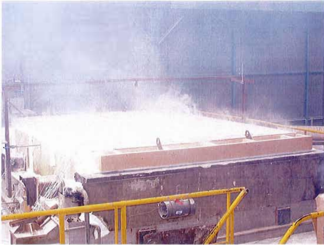
Vue de la face non exposée à 15 minutes d'essai
