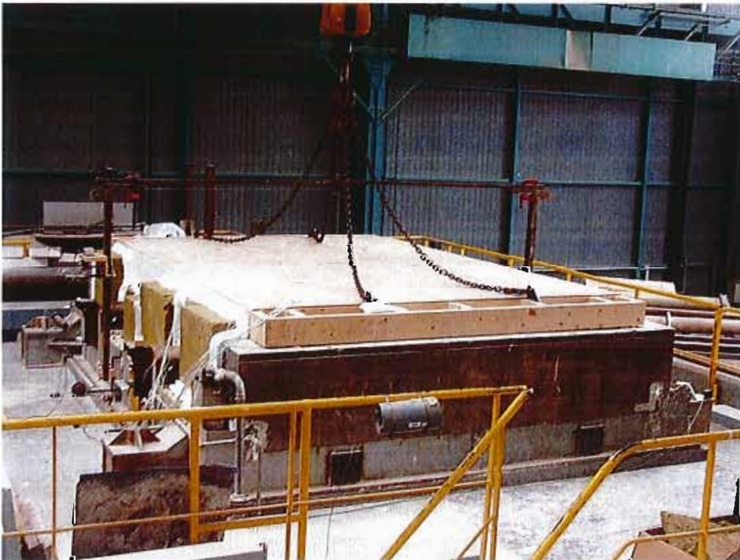
Vue de la face non exposée avant la réalisation de l'essai
