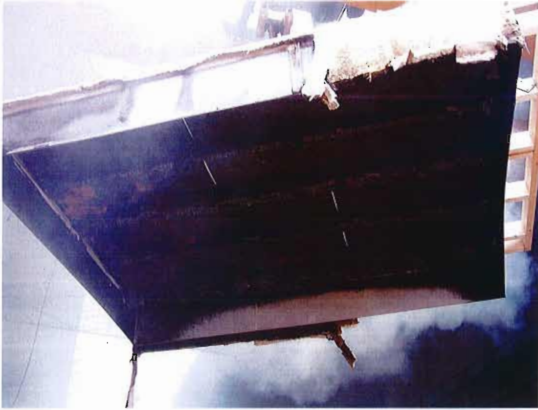
Vue de la face exposée à l'arrêt de l'essai et retrait de l'éprouvette du four
