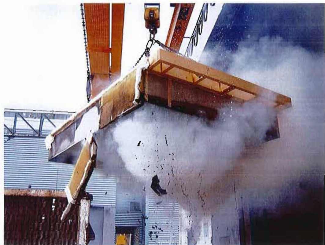
Vue de détail de l'extinction de l'inflammation en face exposée
