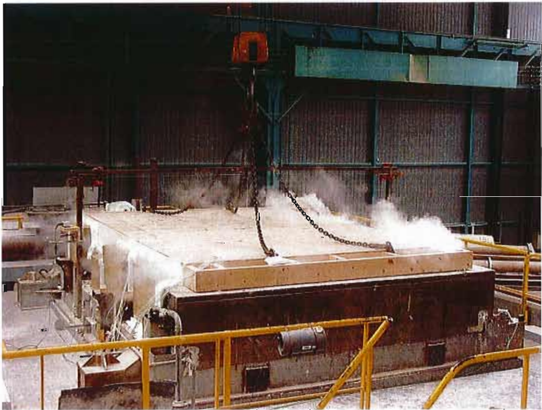
Vue de la face non exposée à 45 minutes d'essai
