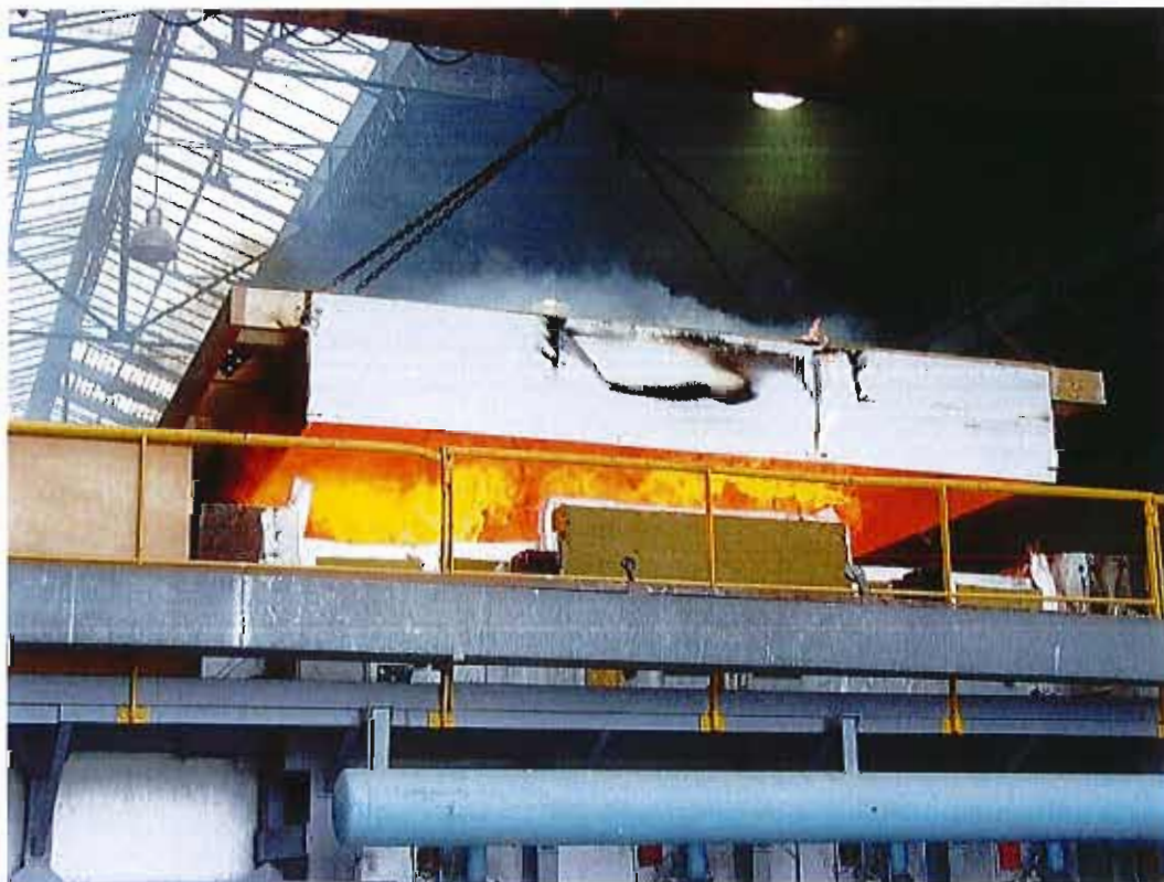
Vue de détail de la face exposée à l'arrêt de l'essai et retrait de l'éprouvette du four
