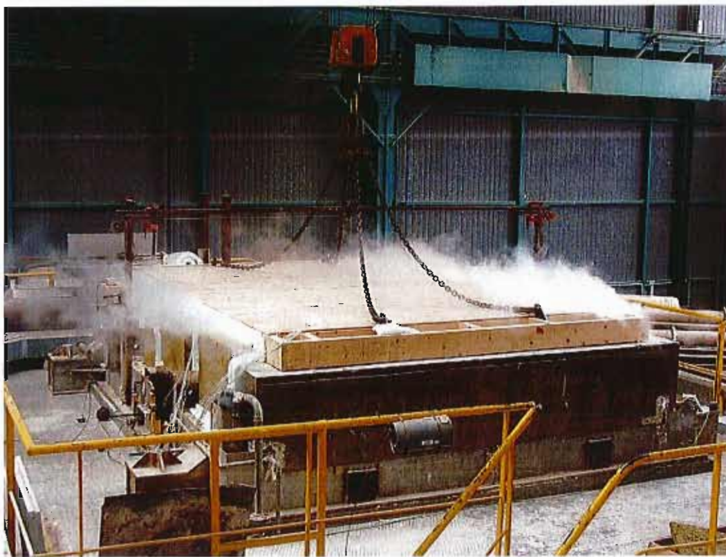
Vue de la face non exposée à 15 minutes d'essai
