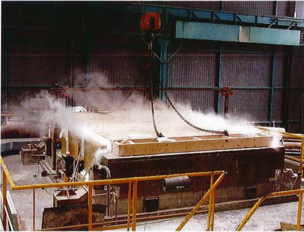
Vue de la face non exposée à 20 minutes d'essai
