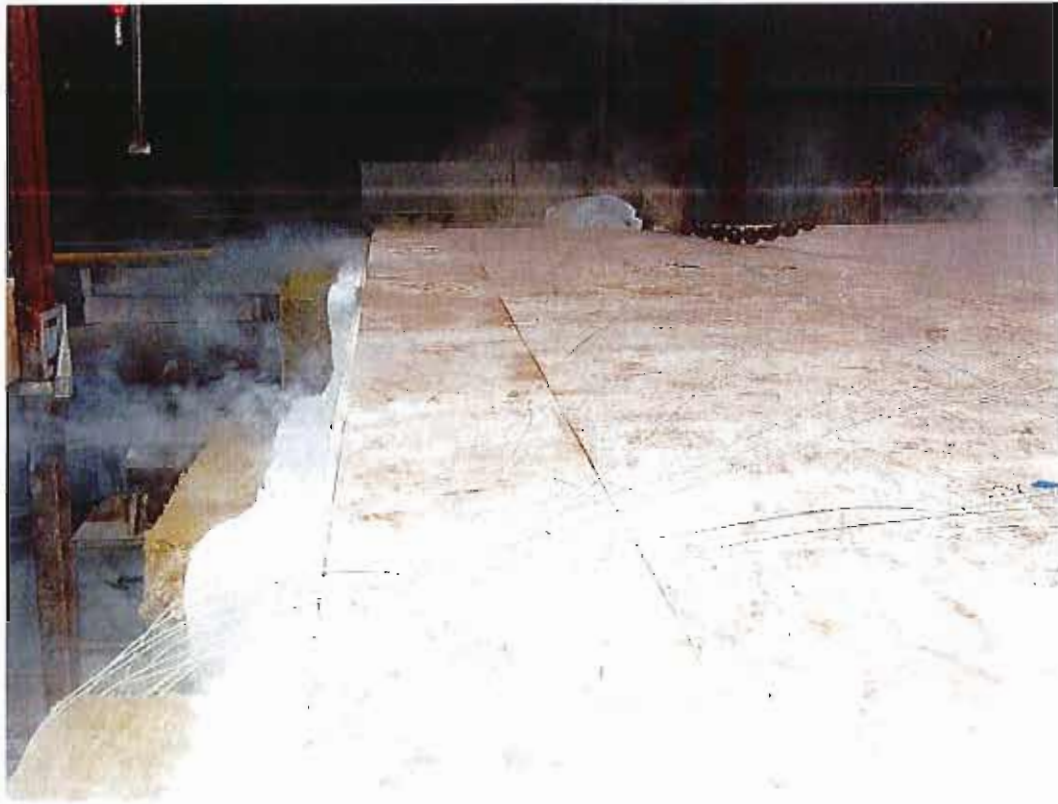
Vue de détail de la face non exposée à 40 minutes d'essai
