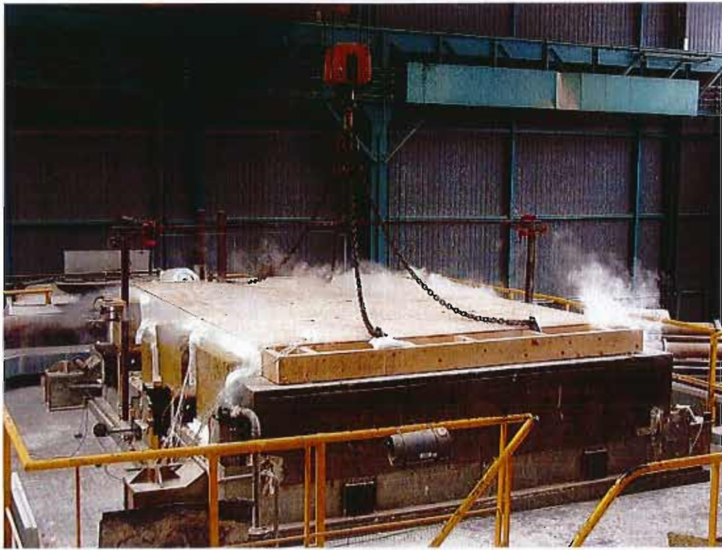
Vue de la face non exposée à 30 minutes d'essai
