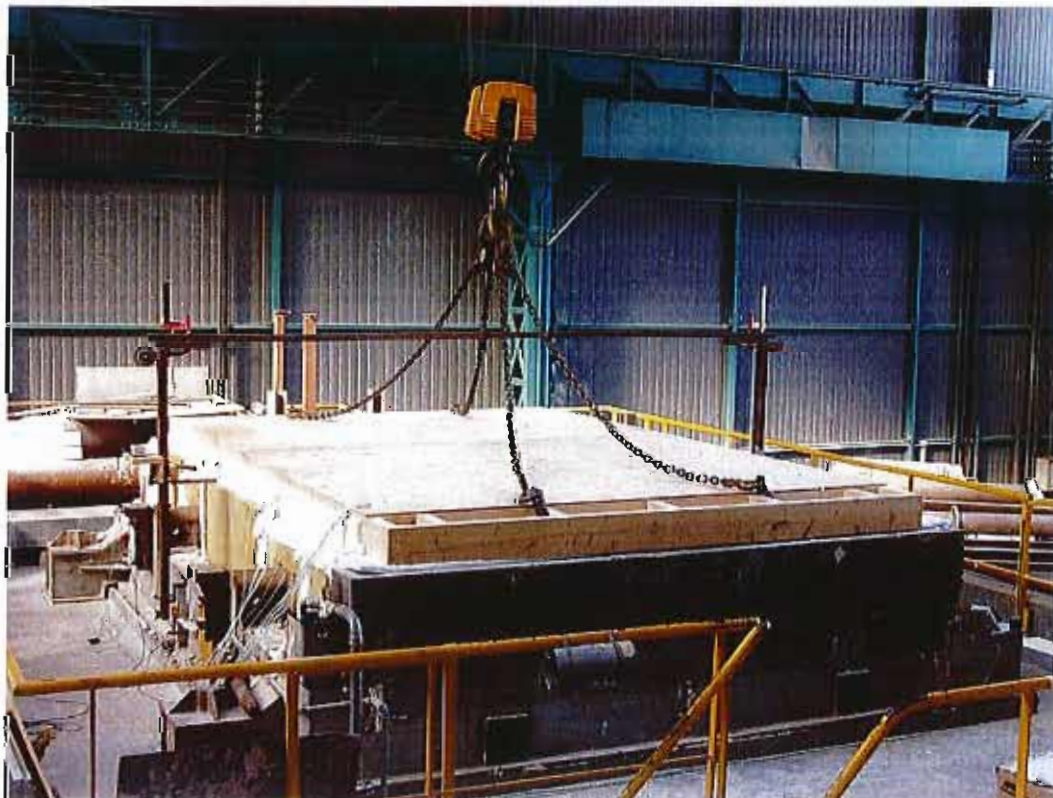
Vue de la face non exposée à 30 minutes d'essai
