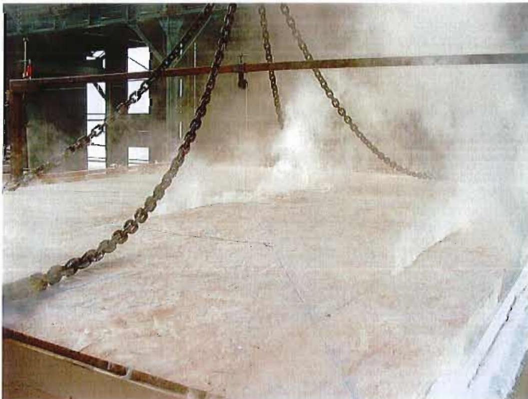
Vue de détail de la face non exposée à 49 minutes d'essai
