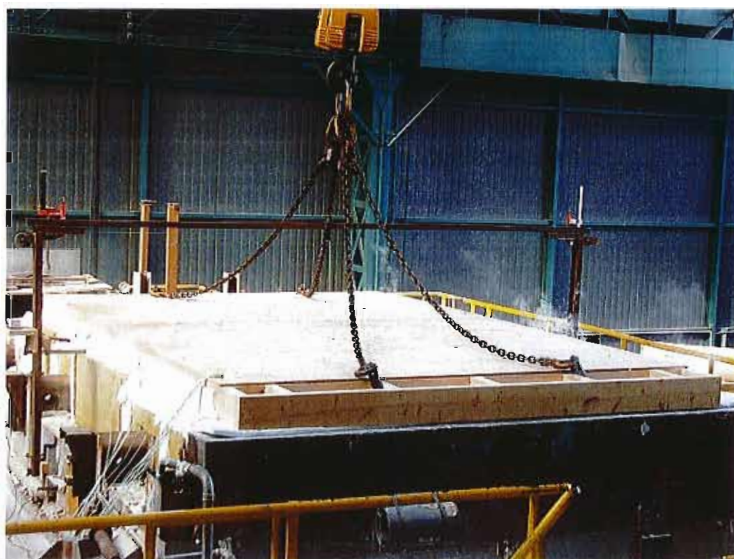
Vue de la face non exposée à 45 minutes d'essai
