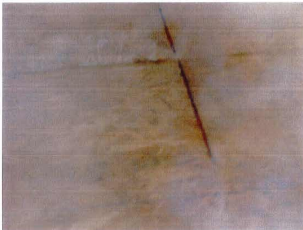
Vue de détail de la face non exposée à 50 minutes d'essai
