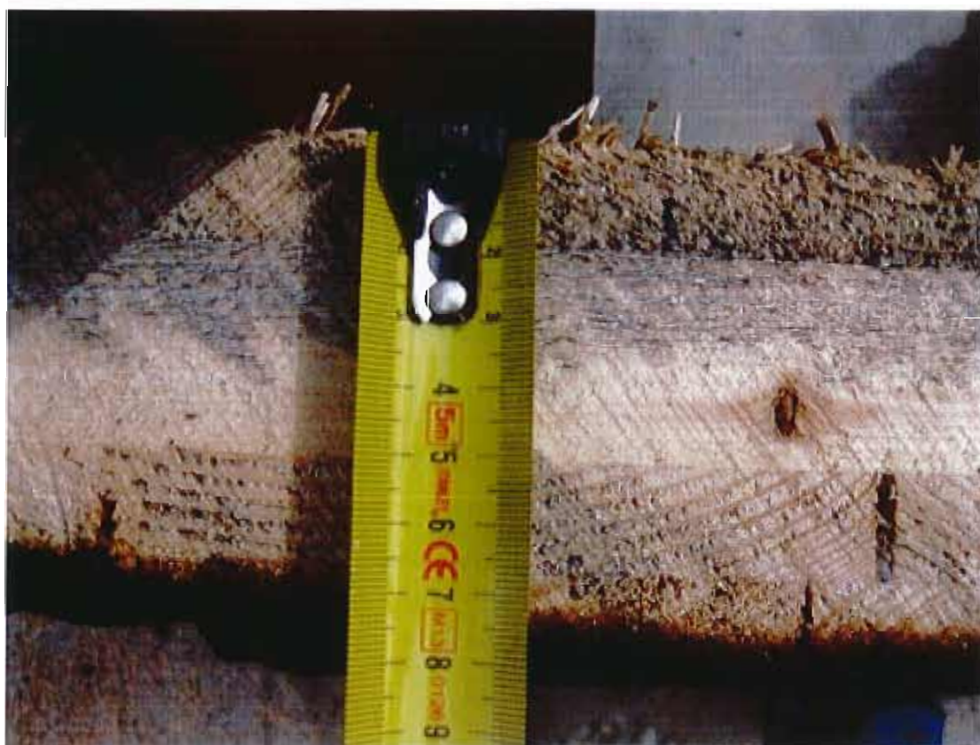
Vues de détail de l'épaisseur de bois sain du morceau prélevé u centre du plancher après la réalisation de l'essai
