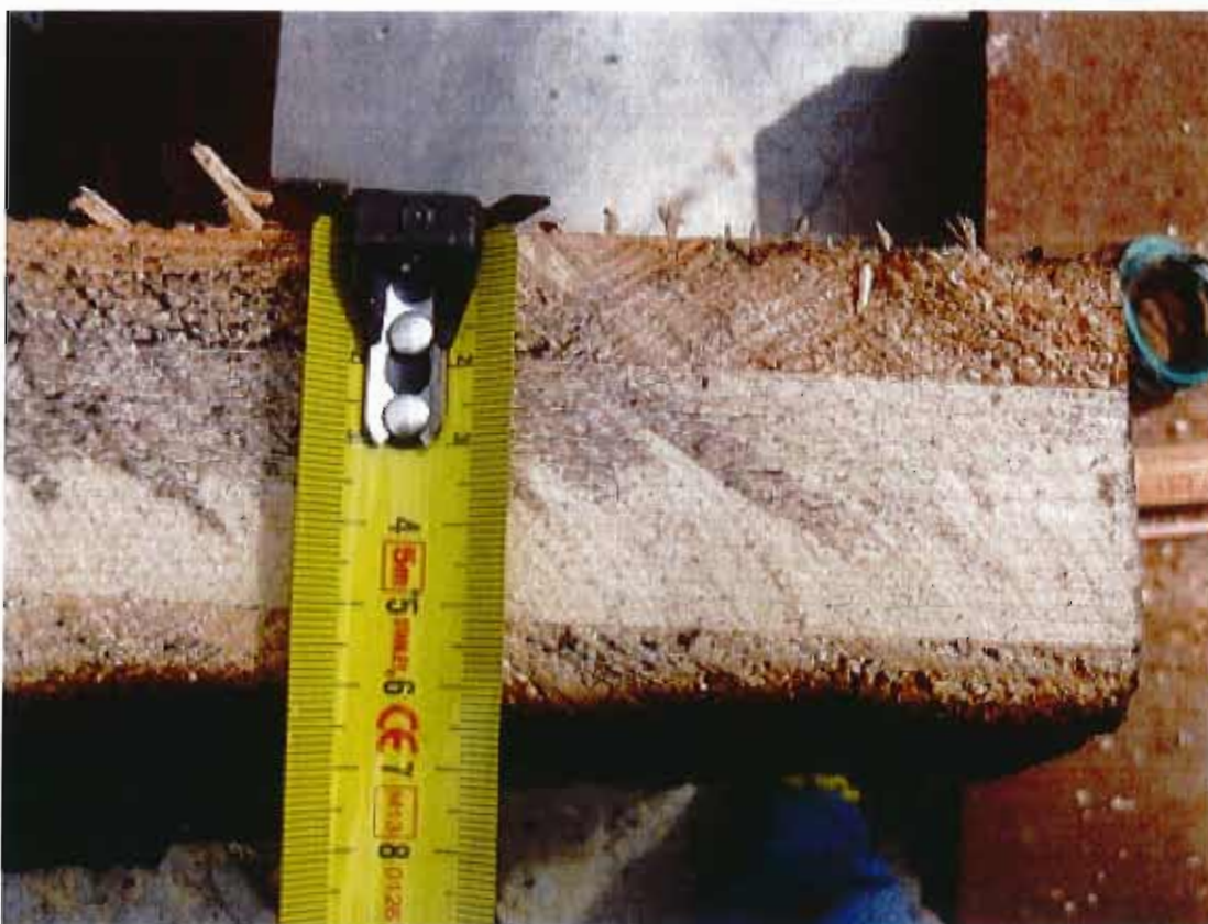
Vues de détail de l'épaisseur de bois sain du morceau prélevé u centre du plancher après la réalisation de l'essai
