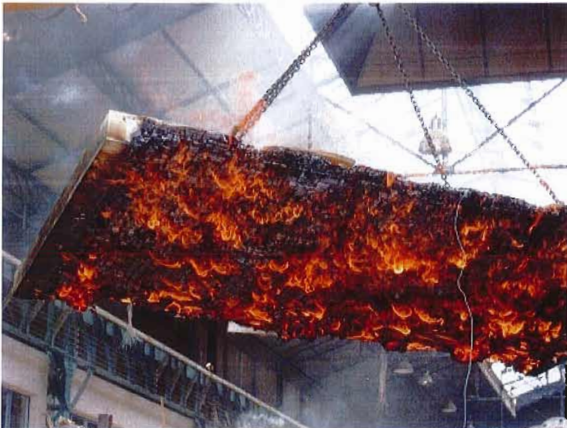
Vues de la face exposée à l'arrêt de l'essai et retrait de l'éprouvette du four
