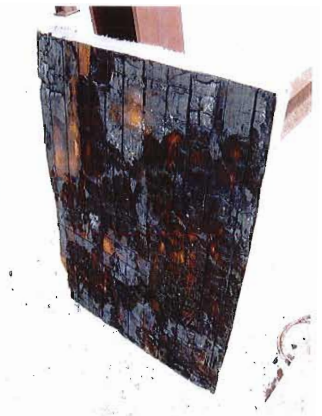
Vues de détail de la face exposée d'un morceau prélevé au centre du plancher après la réalisation de l'essai
