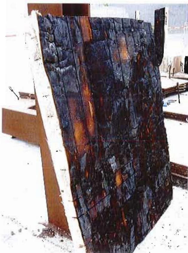
Vues de détail de la face exposée d'un morceau prélevé au centre du plancher après la réalisation de l'essai
