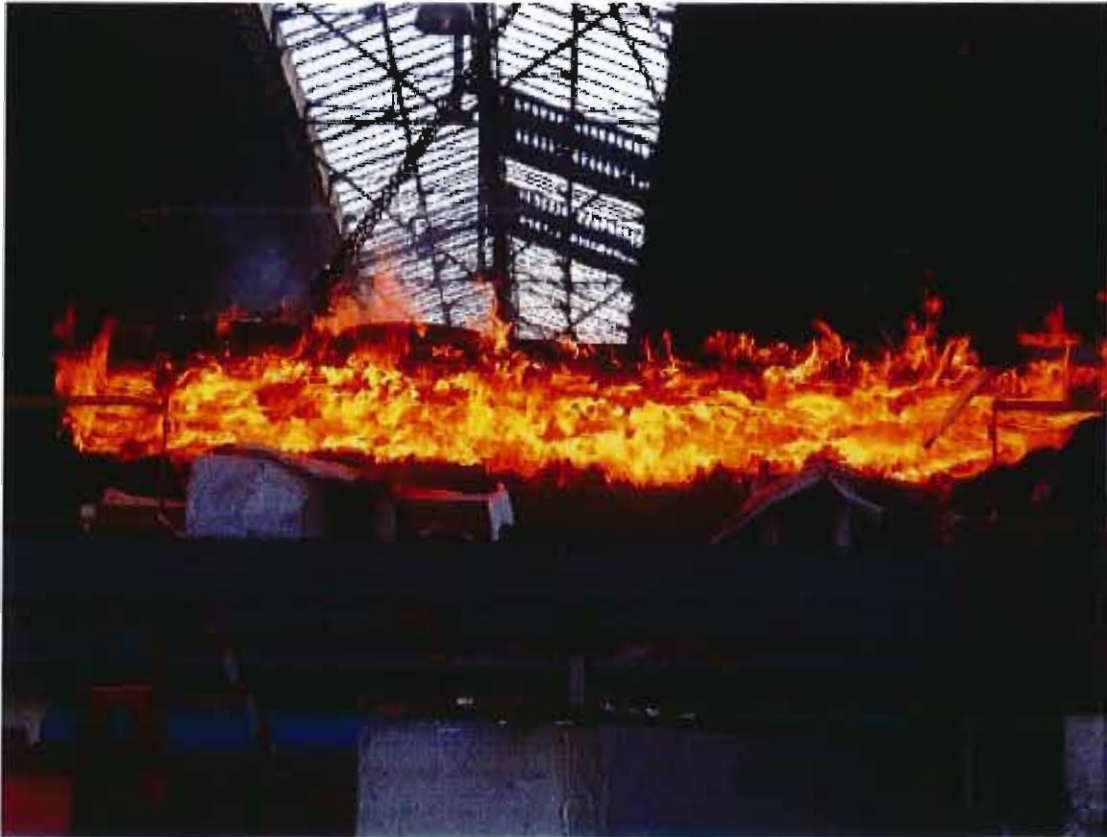
Vues de la face exposée à l'arrêt de l'essai et retrait de l'éprouvette du four
