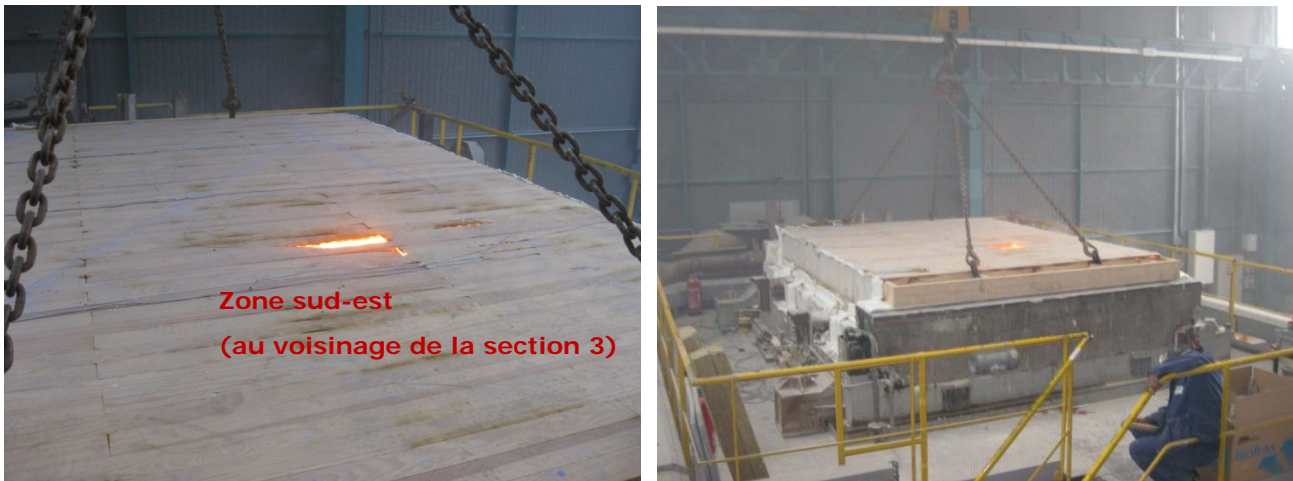
Figure 11 : Détail du percement à 1 heure et 29 minutes d'essai
