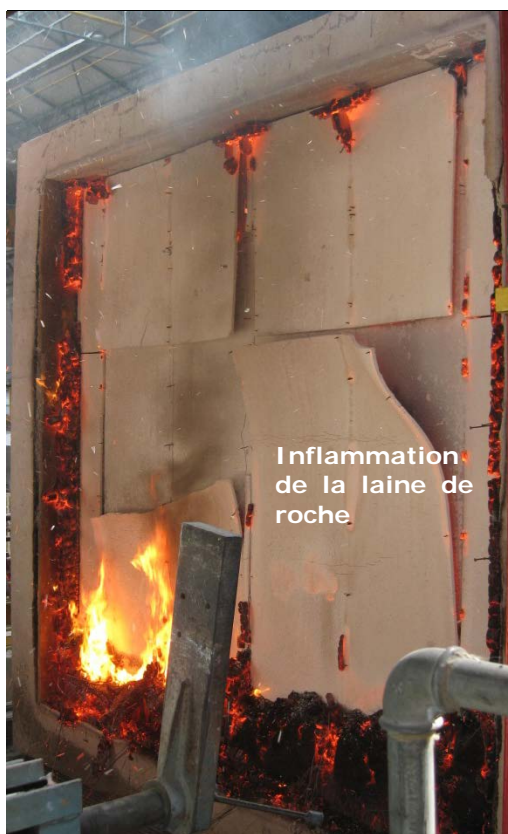
Figure 11 : Détail du de la face exposée du corps d'épreuve juste après l'arrêt de l'essai
