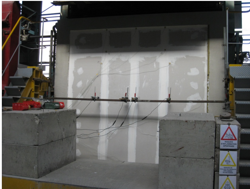
Figure 7 : Photographie du four d'essai
