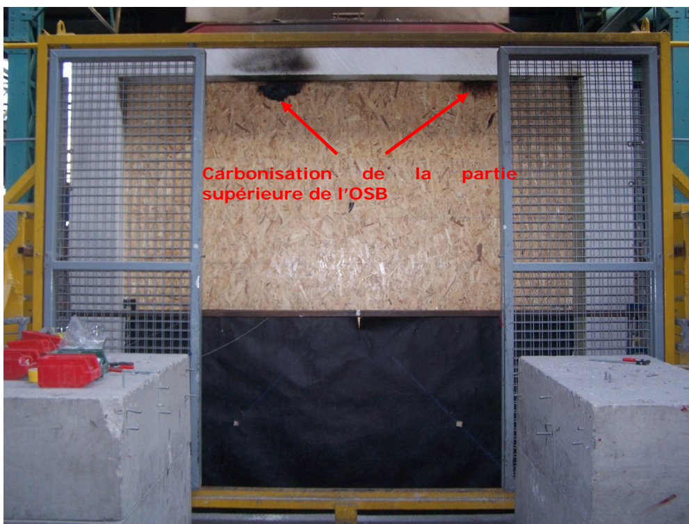
Figure 24 : Photographie de la face non-exposée de l'OSB après l'essai
