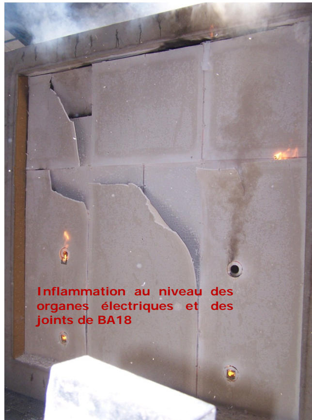
Figure 10 : Détail de la face exposée du corps d'épreuve juste après l'arrêt de l'essai à 1h 20 min
