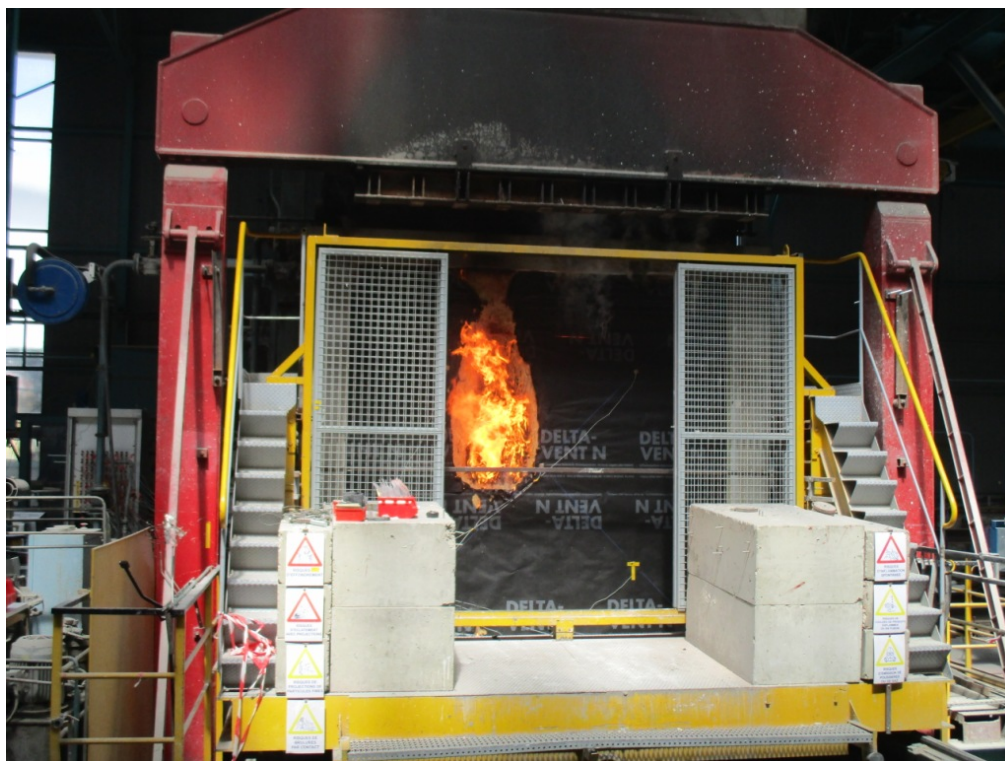
Vue d'ensemble de la face non exposée à l'arrêt de l'essai
