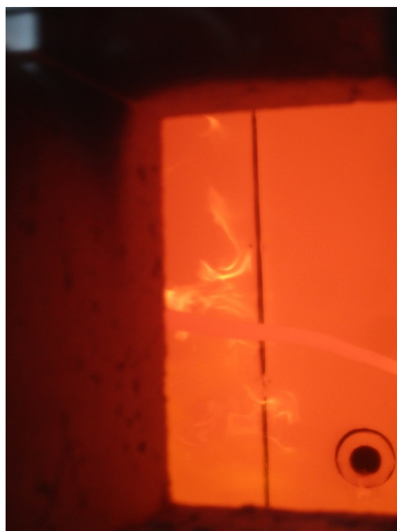
Détail des passages de flammes observés à t = 01 [h] 18 [min] 00 [s]
