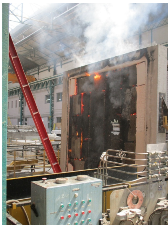
Vue d'ensemble de la face exposée au retrait de la maquette du four
