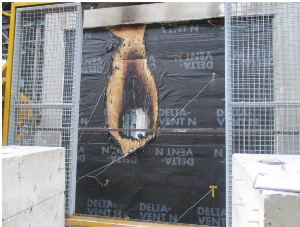
Vue d'ensemble de la face non exposée après refroidissement
