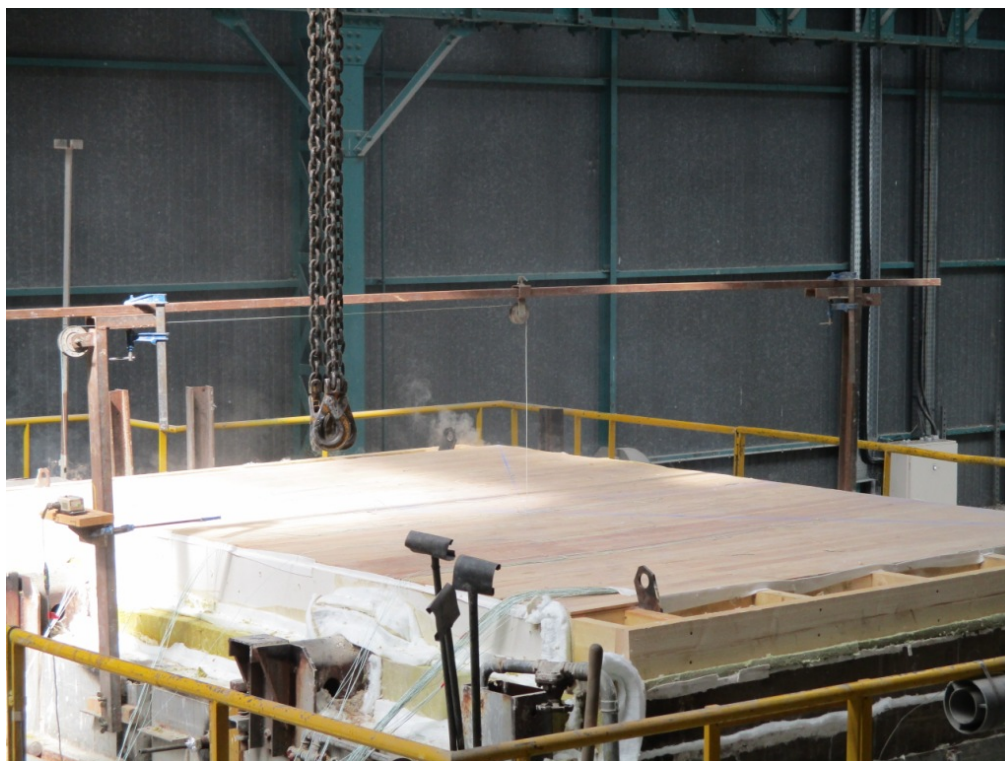
Vue d'ensemble de la face non exposée à t = 30 [min] 00 [s]
