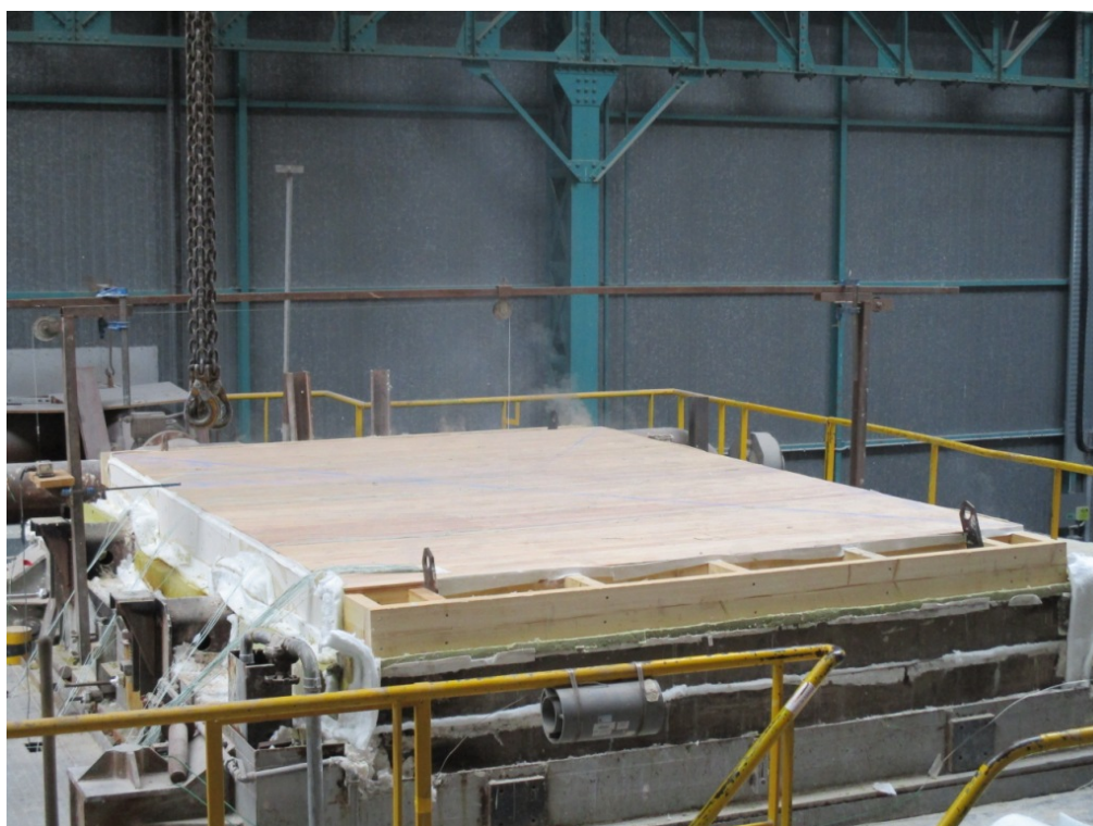
Vue d'ensemble de la face non exposée à t = 45 [min] 00 [s]
