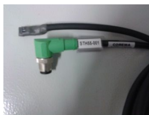
Figure 5: Capteur de température et Humidité relative : STH 55 (Newsteo) Température : -25 à +80^{\circ}\text{C} \pm 0,4^{\circ}\text{C} HR : 0 à 100\% \pm 2\%
