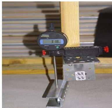
Figure 22 : comparateur en bout de pige fixée à l'aplomb des entrains pour la mesure de la flèche.
