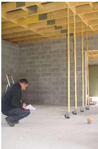
*Figure 5 : photos de la charge de 300 kg et des piges instrumentées de comparateur pour la mesure de la flèche des entrails.*
