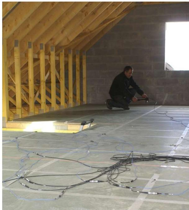
Figures 6 : à gauche, schéma représentant le maillage réalisé pour l'AME, les points d'impact au marteau étant en rouge. A droite, impact au marteau.
