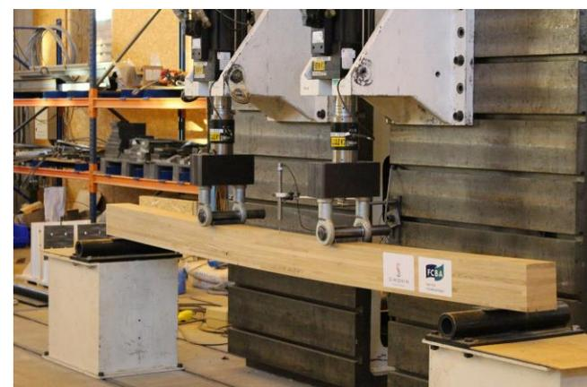
Photos 2 : Test de flexion sur une poutre en lamellé collé de chêne au Laboratoire mécanique de FCBA Bordeaux
