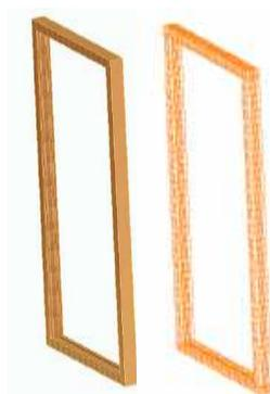
FIGURE 2.31 – Géométries et maillages du modèle recalé du cadre de l'ouvrant.
