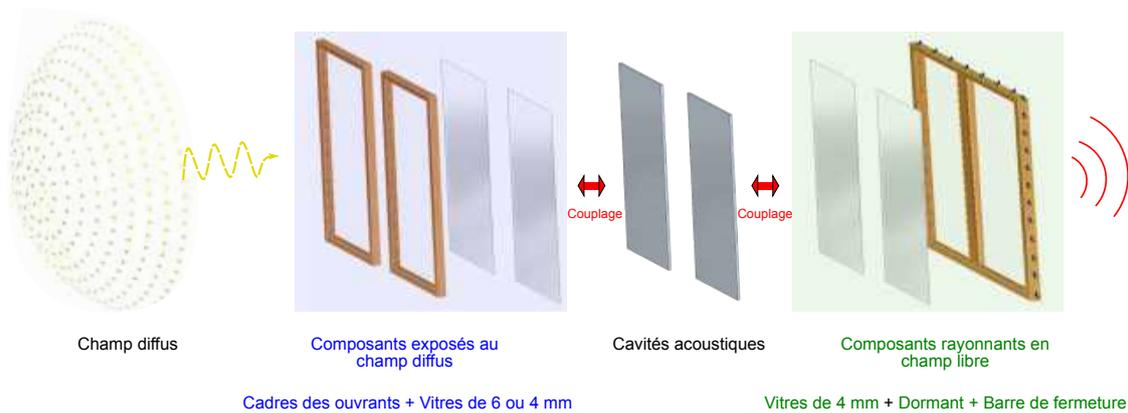
FIGURE 5.5 – Les composants de la fenêtre exposés à l’excitation acoustique et ceux qui rayonnent en champ libre.
