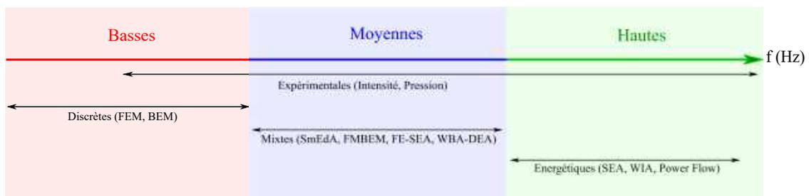
FIGURE 1.21 – Quelques méthodes de résolutions des problèmes vibro-acoustiques.
