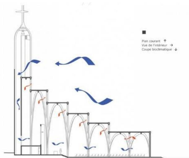
Figure 45 : Coupe de l'église et principe de ventilation © In Situ
