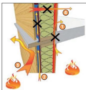
Résistance au feu du côté intérieur.  $E_i > 0$  : l'exigence de résistance est identique à celle de la structure porteuse du reste du bâtiment si la paroi est porteuse.
