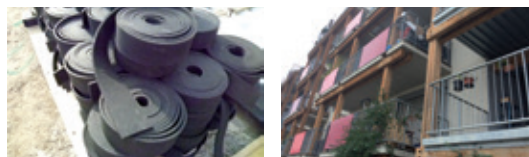
Les bandes résilientes sous les dalles béton permettent de diminuer les bruits d'impact.
