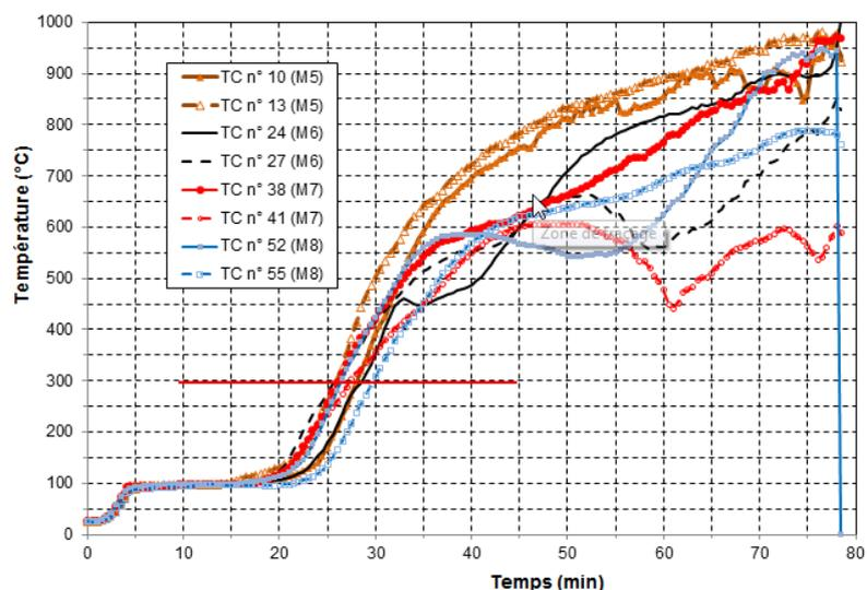
**Figure 3.1.4 : Températures mesurées à l'interface montant-parement côté feu (M5 à M8).**
