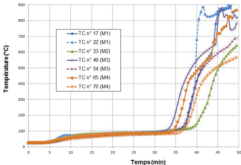
**Figure 3.1.1 : Températures mesurées sur la face côté isolant du parement côté feu (M1 à M4).**
