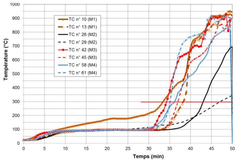
**Figure 3.1.3 : Températures mesurées à l'interface montant-parement côté feu (M1 à M4).**
