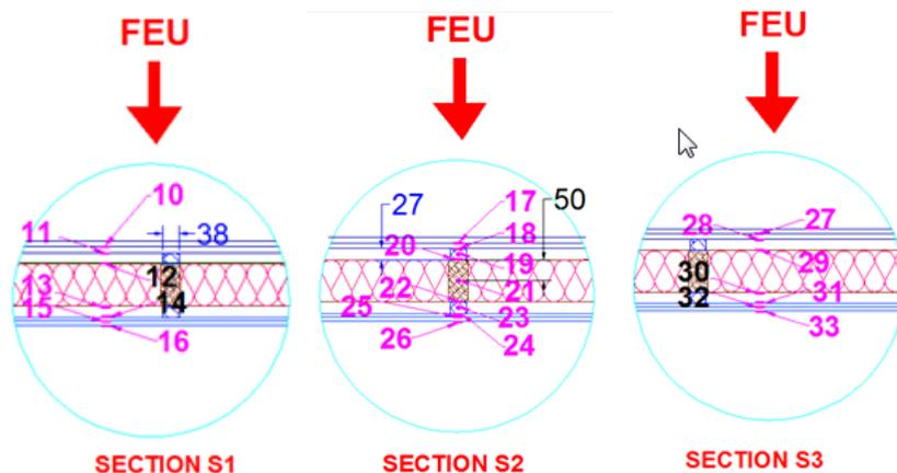
A1-4 - Positionnement des thermocouples de l'essai RS11-053/E.
