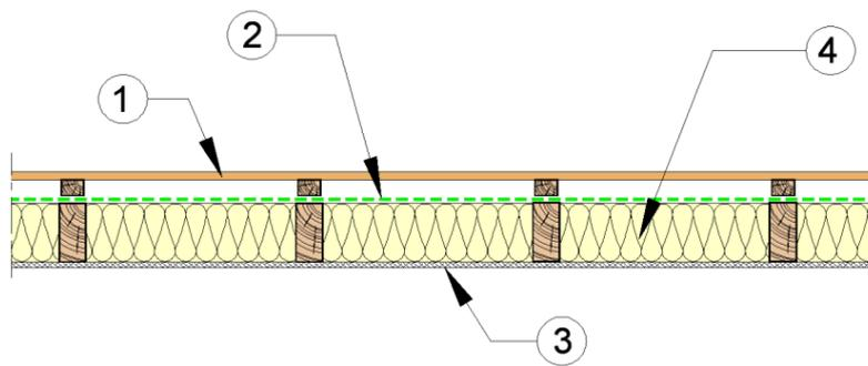
**Figure 2.1.3 : Coupe horizontale des parois testées au feu.**
