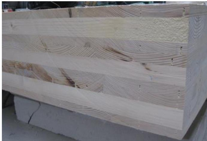
**Tableau 2.2.2 : Plancher CLT d'épaisseur 195 testé au feu.**
