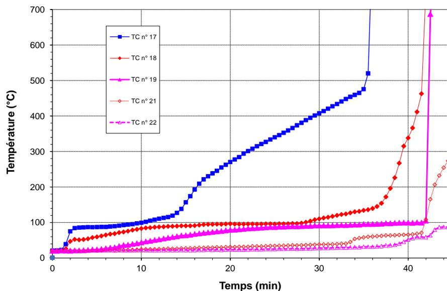
**Figure 3.2.2 : Températures mesurées sur l'axe d'un tasseau et d'un montant bois (essai RS11-053/E).**
