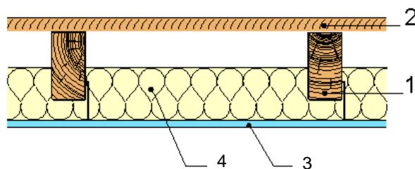
**Figure 2.2.2: Coupe verticale de plancher testé (type 1 : 9 configurations).**
