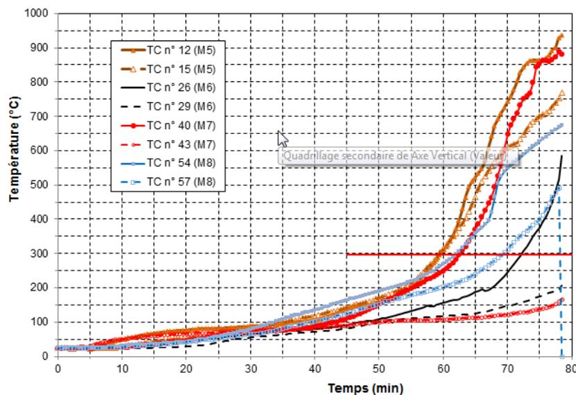
**Figure 3.1.6 : Températures mesurées au centre des montants (M5 à M8).**
