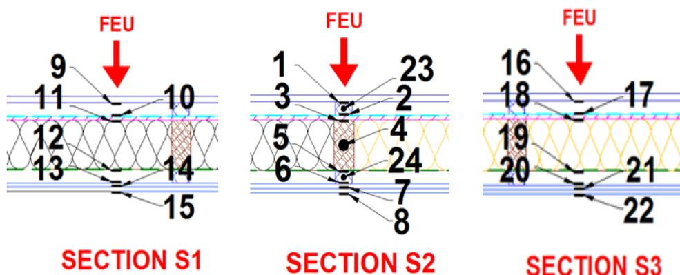
A1-6 - Positionnement des thermocouples de l'essai RS11-053/I.
