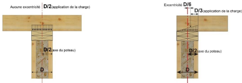
Figure 37 Montant soumis à chargement centré (gauche) ou chargement excentré (droite)
