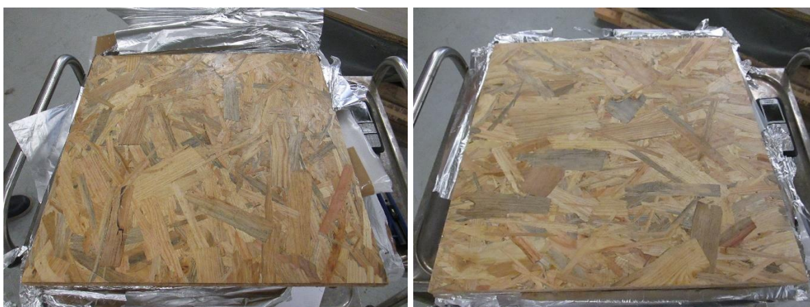
Photo 1 : Echantillons de panneau OSB avant découpe et colmatage
