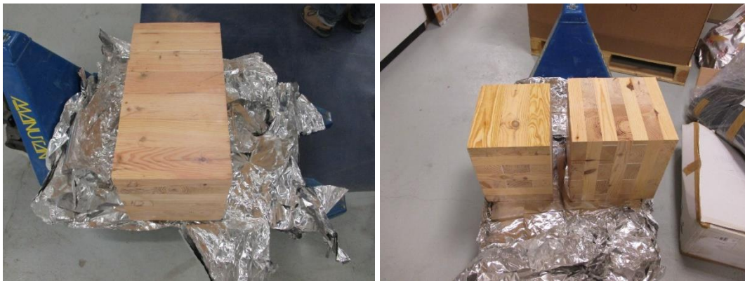
Photo 4 : Echantillon de CLT avant et après découpe
