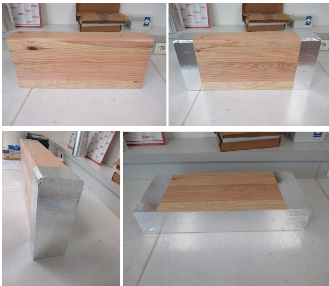
Photo 3 : Eprouvette d'essai de BLC avant et après colmatage
