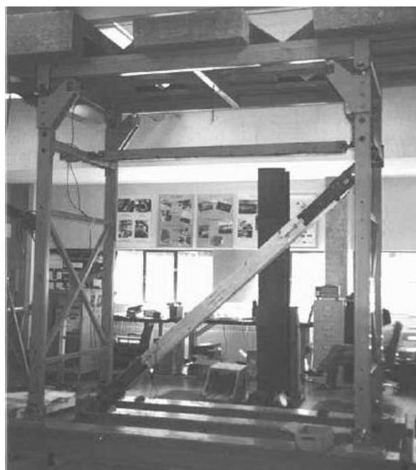
*Figure 11 : cadre métallique avec diagonale de contreventement testé sur table sismique.*
