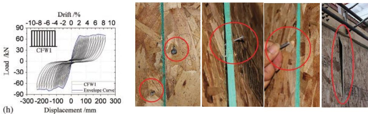
Figure 33: courbes cycliques et enveloppes expérimentales et faciès de rupture pour les systèmes poteaux poutres contreventés avec murs ossature bois (CFW).
