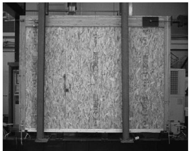
*Figure 1: schéma et photo d'une structure poteau/poutre contreventée par murs à ossature bois positionnés "en tunnel".*
