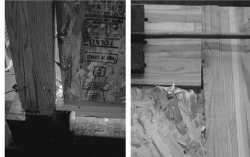
Figure 22: courbes cyclique, enveloppe bi-linéaire expérimentales et modes de ruptures pour la structure poteaux/poutres contreventée SIP.
