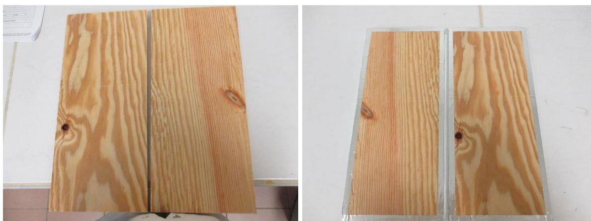
Photo 3 : Eprouvettes d'essai après découpe de l'échantillon 16/1159R/2 et colmatage
