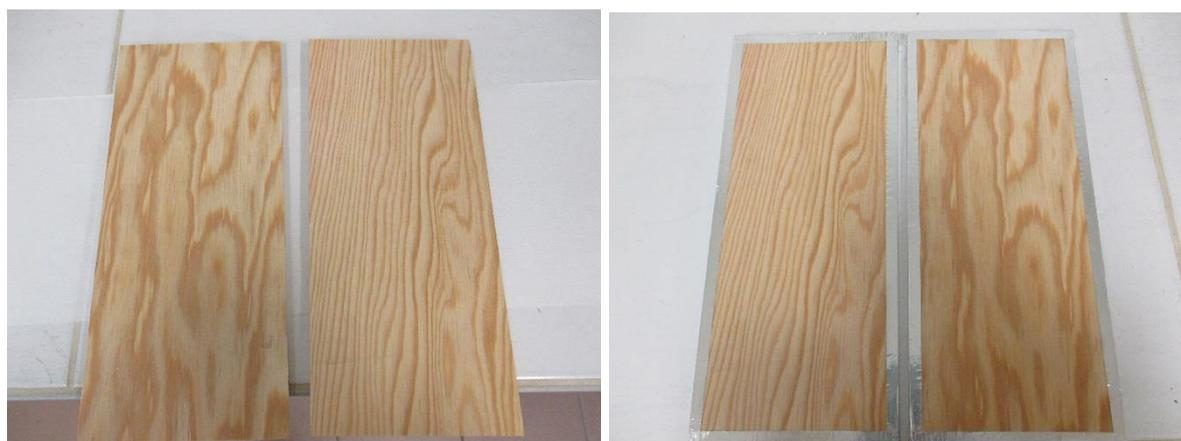
Photo 1 : Eprouvettes d'essai après découpe de l'échantillon 16/1159R/1 et colmatage
