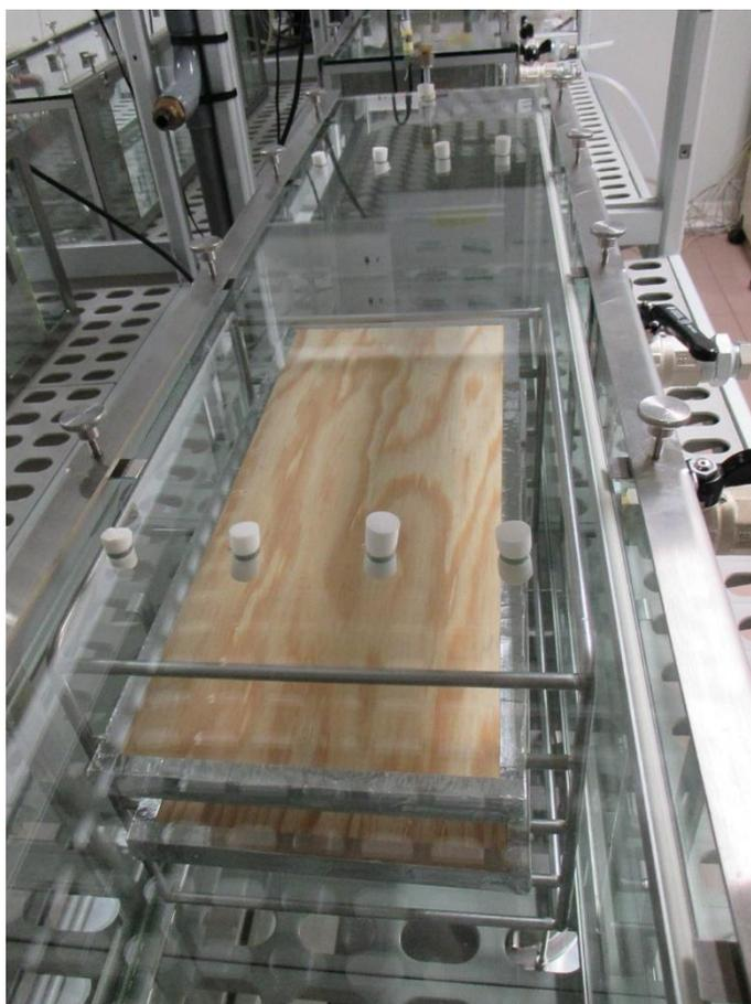
Photo 2 : Eprovettes d'essai en chambre d'essai d'émission (16/1159R/1)
