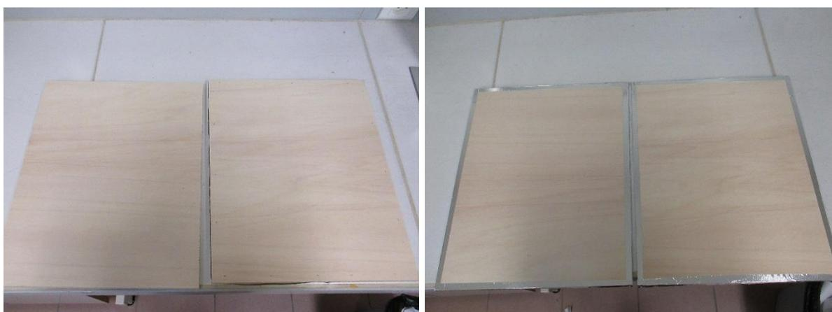
Photo 5 : Eprouvettes d'essai après découpe de l'échantillon 16/1159R/3 et colmatage
