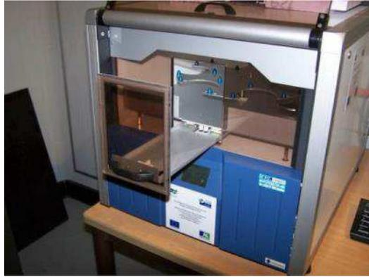
**Figure 13: Appareil permettant de mesurer la perméabilité à la vapeur d'eau**
