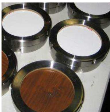
**Figure 11: Eprouvettes revêtues dans les coupelles de test**
