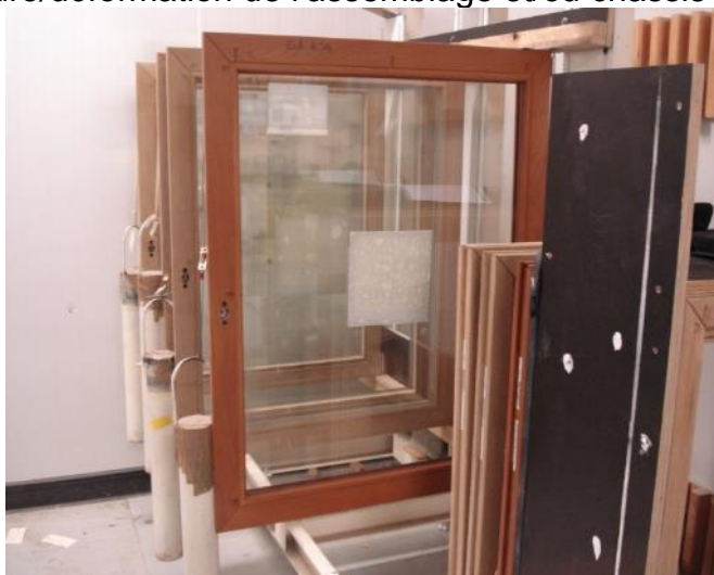
Photo 1 : vantaux dans enceinte climatique (humide puis sec) avec charge verticale de 25daN au battement
