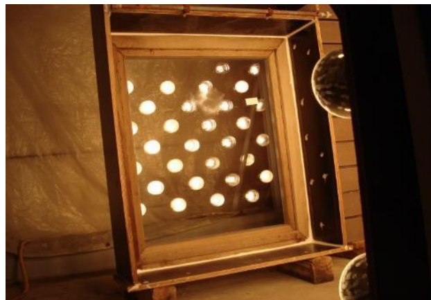
Photo 2 : Exposition du parement extérieur du châssis à un arrosage (15jours) puis à un rayonnement IR (15jours)
