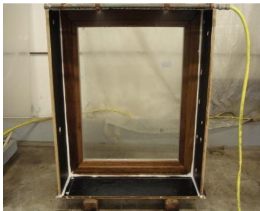
Photo 2 : Exposition du parement extérieur du châssis à un arrosage (15jours) puis à un rayonnement IR (15jours)
