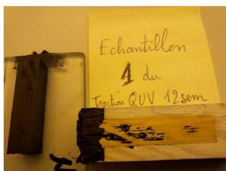
**Photo 4 : rupture adhésive entre interface mastic et bois brut**
