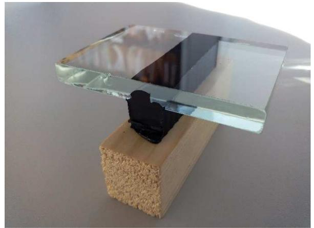
**Photo 2 :** éprouvette avion avec mastic silicone
