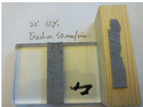
Photo 5 : rupture adhésive entre interface mastic et bois brut
