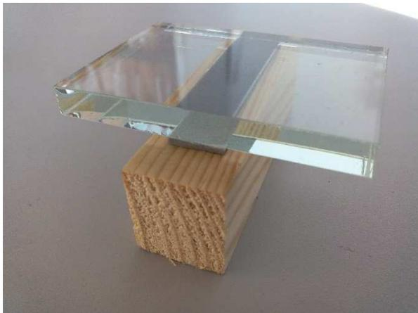
**Photo 1 :** éprouvette avion avec ruban 3M
