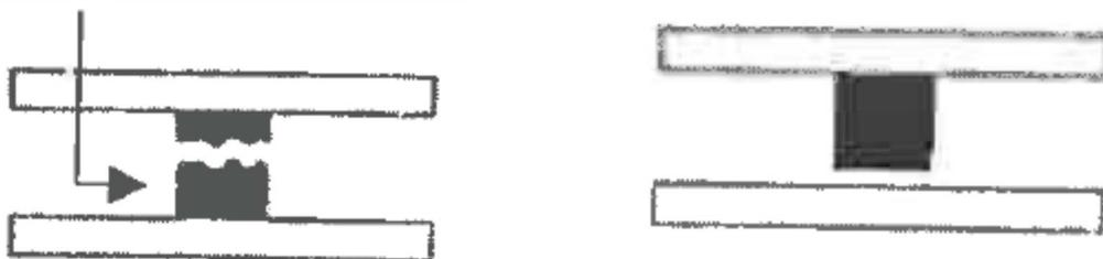
Figure 6 : rupture « cohésive dans le mastic » ou « adhésive » à l'interface mastic - support
