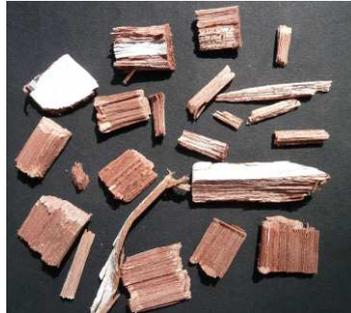
Figure 4 : Photographie des copeaux de bois de fenêtre en Meranti avec des particules de peintures et de mastic.
