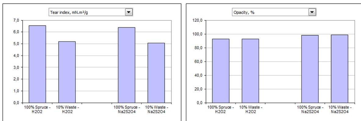
Figure 32: Comparaison de l'indice de déchirement et de l'opacité des pâtes TMP blanchies à 120 ml CSF produites avec des copeaux d'épicéa frais (Spruce) ou un mélange contenant 10% des copeaux issus de palettes (deuxième lot – Waste) (H2O2 pour peroxyde d'hydrogène, Na2S2O4 pour dithionite de sodium).
