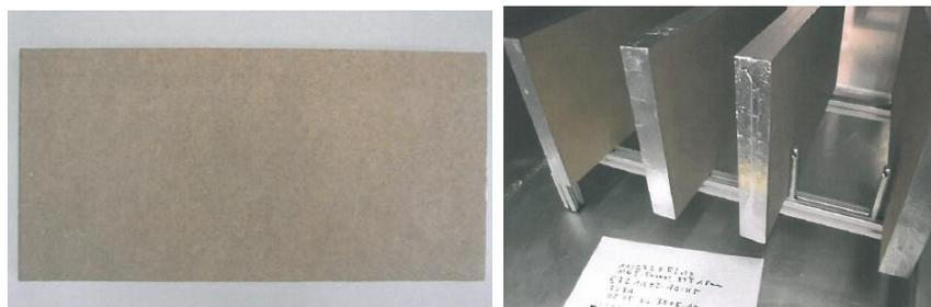
Photo 13 : Echantillon 11/2728R/13 en chambre d'essai d'émission
