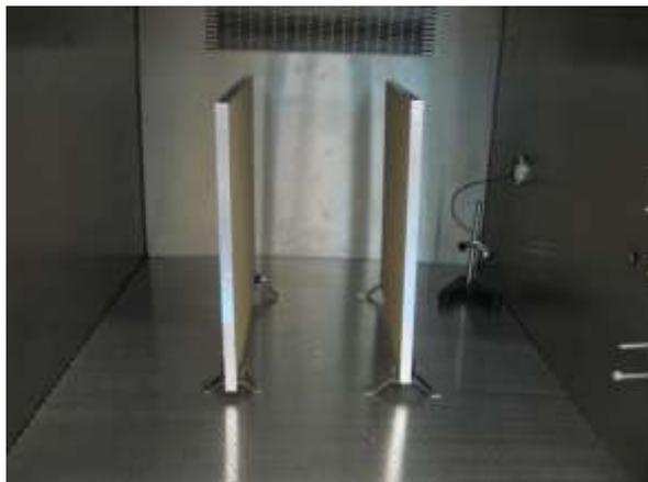
*Photo 6 : Echantillon 13/1163R/4 en chambre d'essai d'émission de  $1 \text{ m}^3$*
