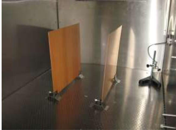
*Photo 5 : Echantillon 13/1163R/2 en chambre d'essai d'émission de  $1 \text{ m}^3$*
