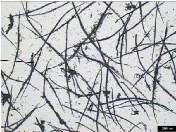
Figure 2 : Microphotographie des fibres composant l'échantillon P2 (uni blanc / 125 g/m<sup>2</sup>) après coloration au réactif de Herzberg au grossissement de 40x
