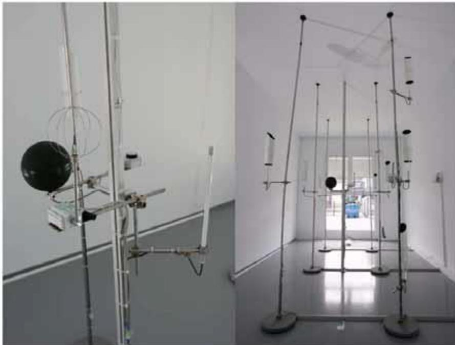
**Figure 15 : Instrumentation à l'intérieure des cellules PASSYS**
