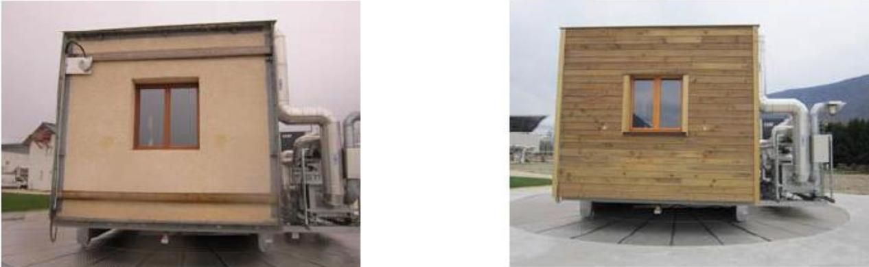
**Figure 14 : Façade épave à gauche sur cellule PASSYS 1 et façades épave + rénovation à droite sur cellule PASSYS 2**
