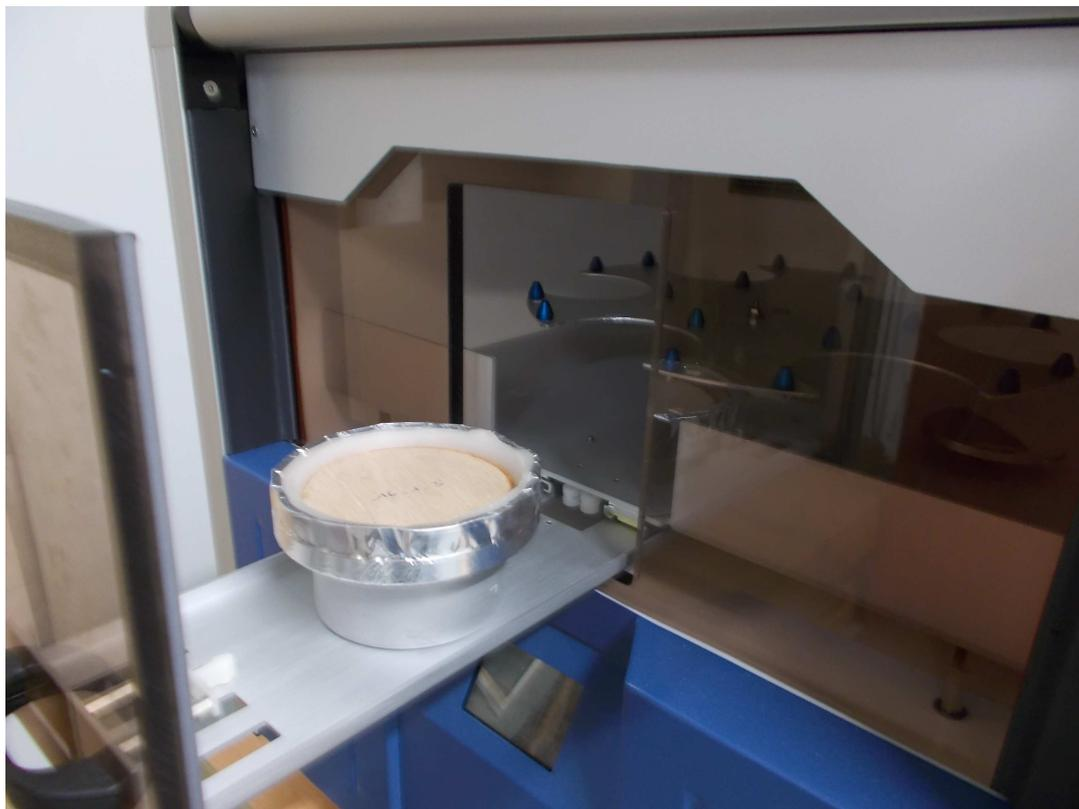
**Figure 3 : Insertion d'une éprouvette dans le « perspiromètre »**
