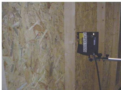
**Photo 2 :** Mesure de la déflexion avec capteur laser
