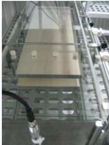
*Photo 7 : Echantillon 11/2719R/7 en chambre d'essai d'émission*
