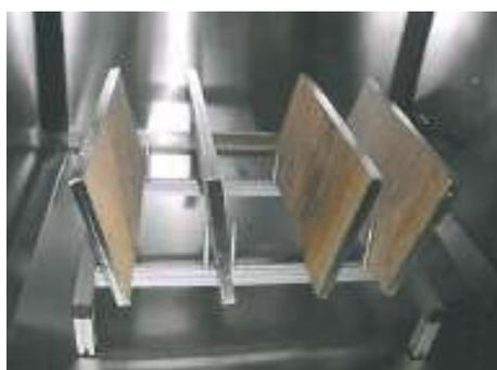
*Photo 12 : Echantillon 11/2719R/12 en chambre d'essai d'émission*
