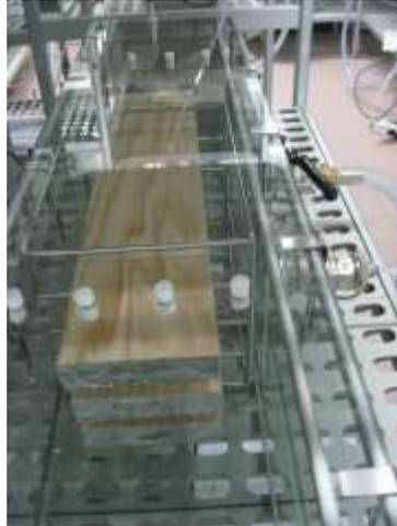
*Photo 3 : Echantillon 11/2719R/3 en chambre d'essai d'émission*
