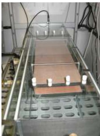
*Photo 10 : Echantillon 11/2719R/10 en chambre d'essai d'émission*
