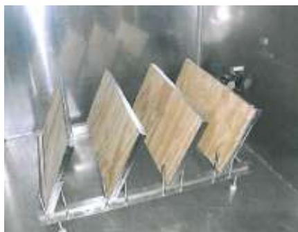
*Photo 11 : Echantillon 11/2719R/11 en chambre d'essai d'émission*
