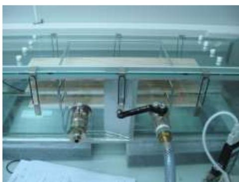
Photo 2 : Echantillon 11/2719R/2 en chambre d'essai d'émission
