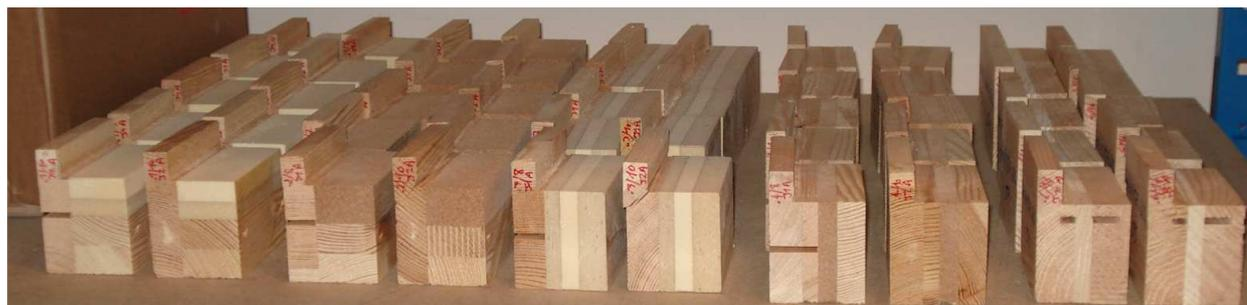
Il s'agit de vérifier la stabilité dimensionnelle et la résistance des joues de feuillures constituant la feuillure de maintien du vitrage. Pour le besoin des essais, une joue de feuillure de dimensions conventionnelles (20mm x 15mm h x l) a été usinée dans les carrelets isolants à tester.
