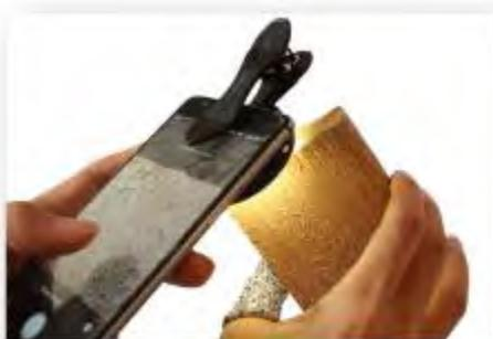
Figure 17 : Positionnement du téléphone et objectif macroscopique pour la prise de photos
