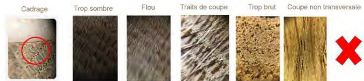
Figure 11 : Exemples d'erreurs sur les premières photos de Chêne effectuées
