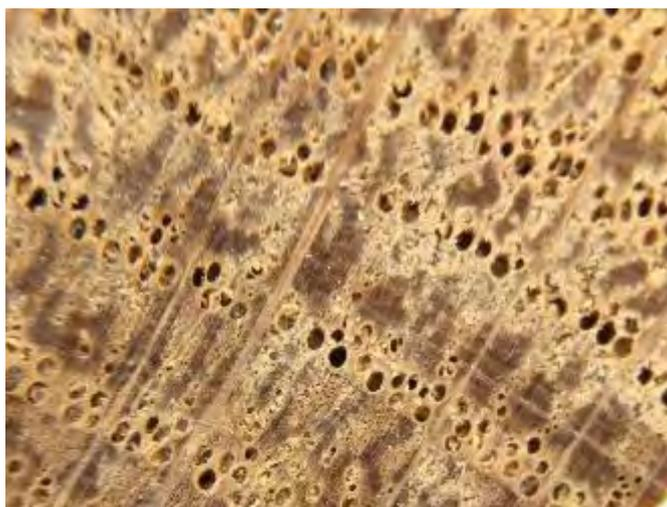
Figure 23 : Coupe transversale du *Quercus* spp. (Chêne européen) grossissement x24 (image Xylorix)
