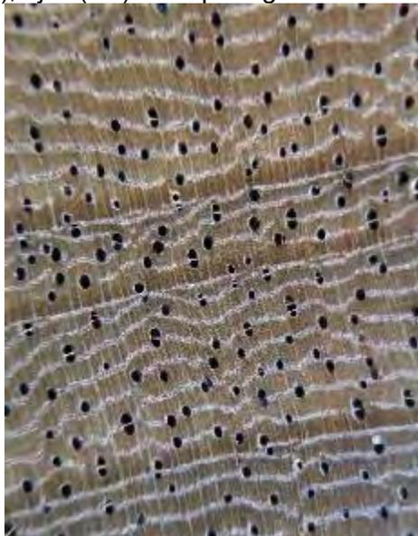
Figure 26 : Coupe transversale du *Entandrophragma utile* (Sipo) grossissement x24 (image Xylorix)
