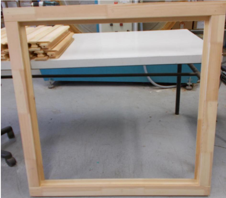
**Figure 2 : cadres réalisés avant application des finitions puis découpe des éprouvettes**
