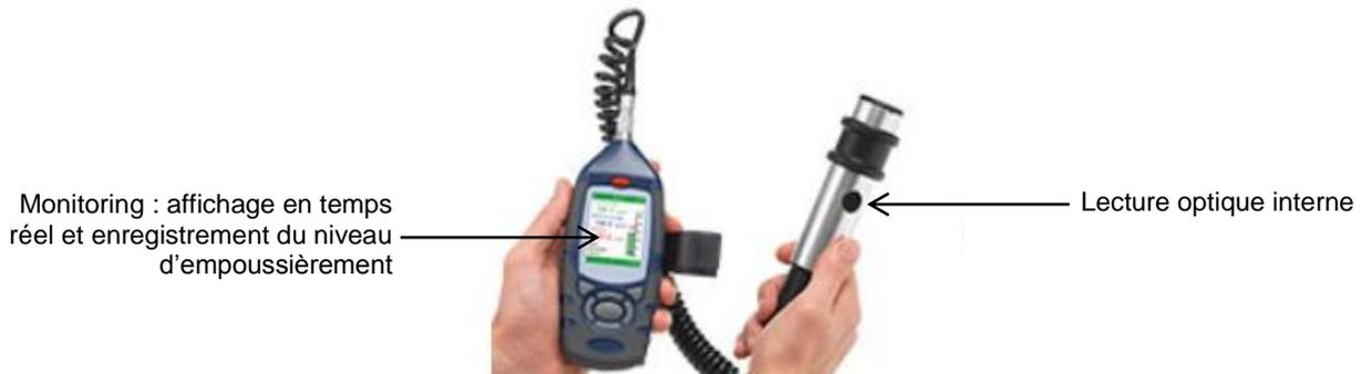
Figure 2 – Dispositif de mesure optique CASELLA CEL – 712 MicroDust Pro
