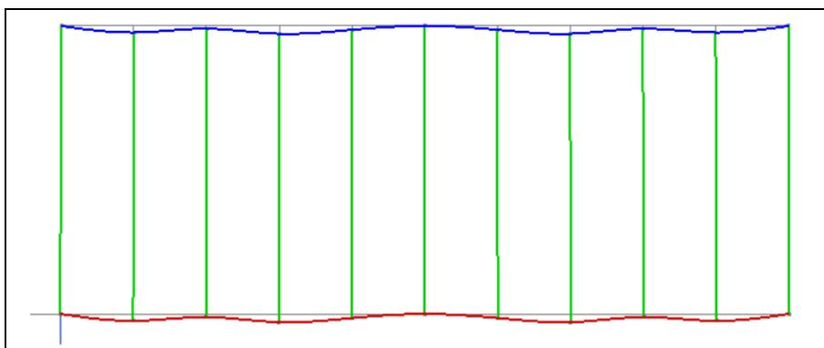
**Figure 2 : Déformée sous charges gravitaires - Façade Filante posée avec appuis multiples**
