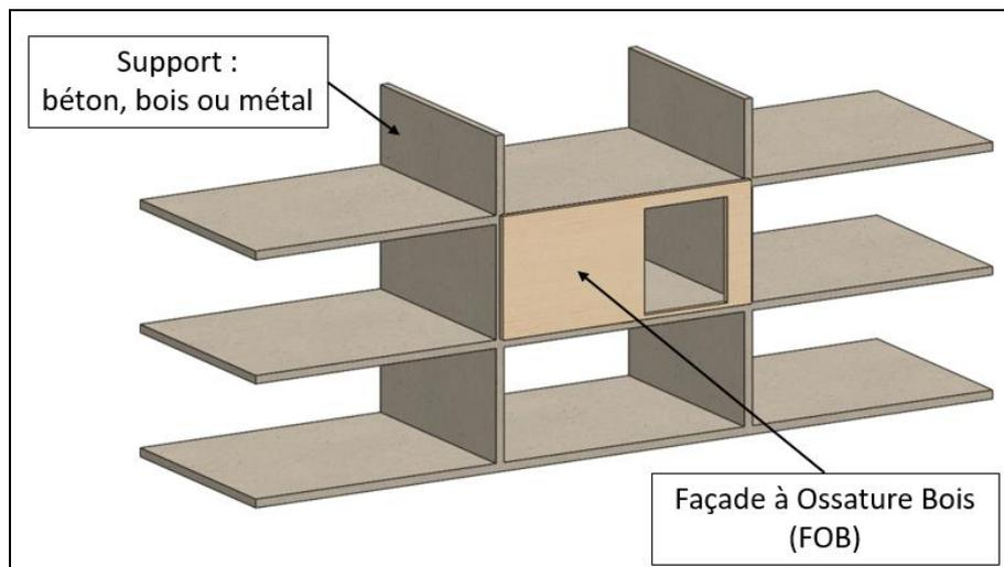
Le dimensionnement des Façades à Ossature Bois et de leurs assemblages est établi conformément aux règles de calcul Eurocodes.
