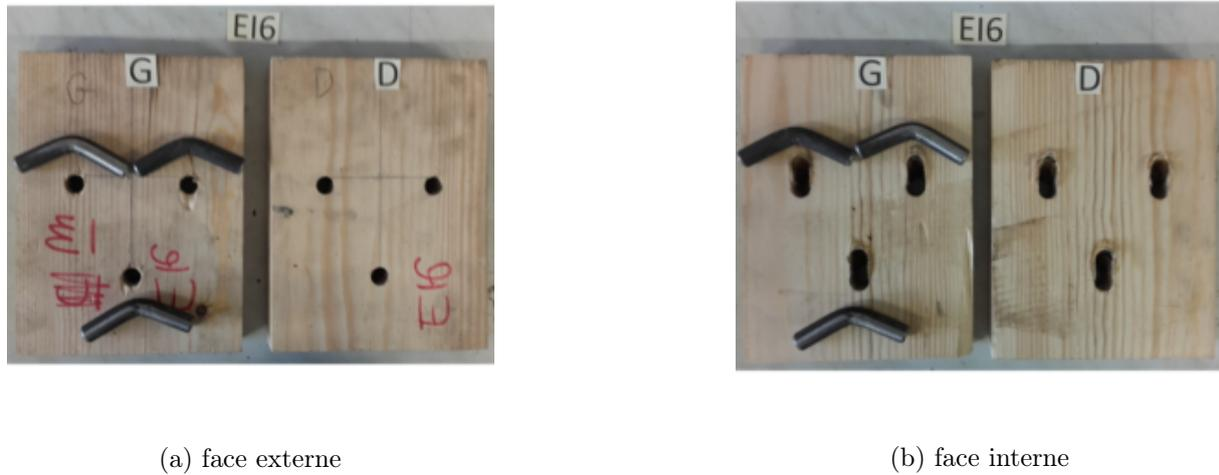
FIGURE 2.12 – Profil de rupture et de plastification pour un essai monotone axial sur assemblage (échelle 1, éprouvette *EI6*)
