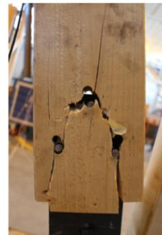
(b) éprouvette 1 : rupture de bloc en pied de diagonale
