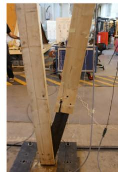
(d) éprouvette 3 : rupture par traction perpendiculaire au fil en pied de diagonale
