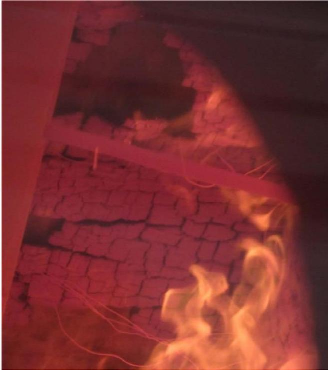
Chute de parties du panneau de coffrage ( $t_{fi} = 34$  min)
