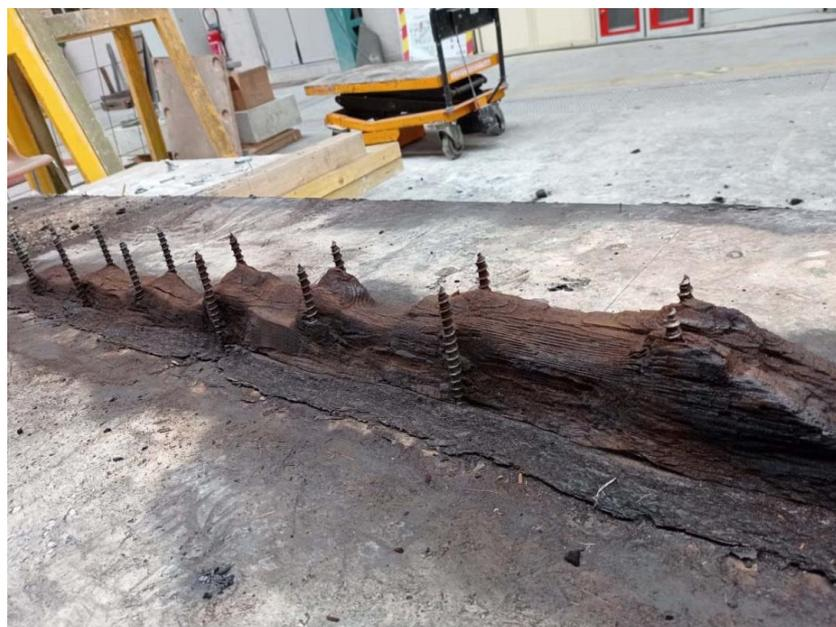
Poutre après retrait du bois carbonisé (3hrs après arrêt de l'essai)
