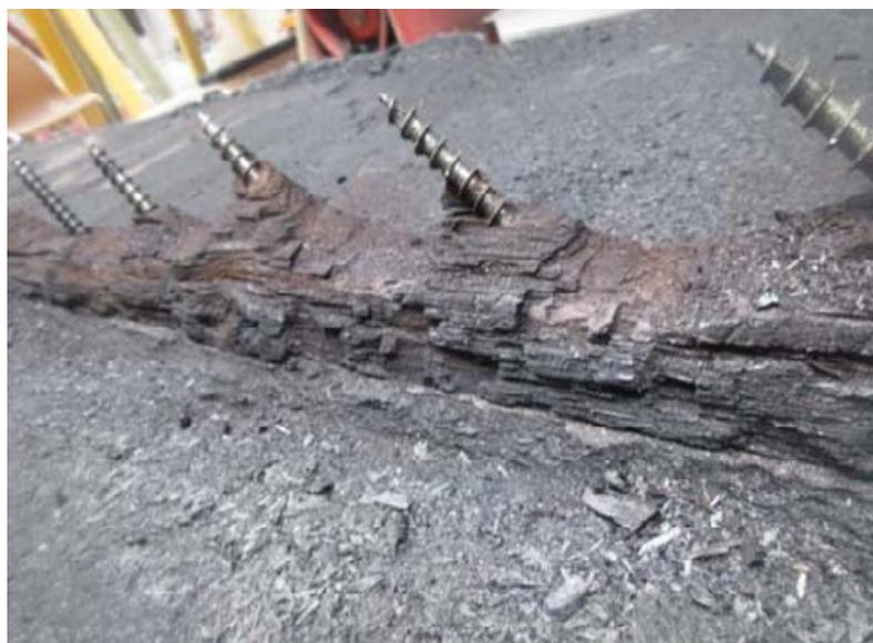
Poutre après retrait du bois carbonisé (2hrs après arrêt de l'essai)
