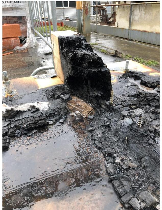
Poutre après retrait du bois carbonisé (2hrs après arrêt de l'essai)
