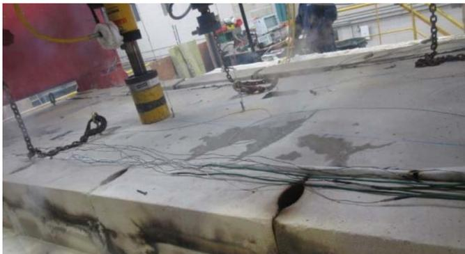
Tâches de condensation ( $t_{fi} = 43$  min)
