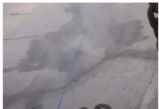
Fissures transversales ( $t_{fi} = 43$  min)
