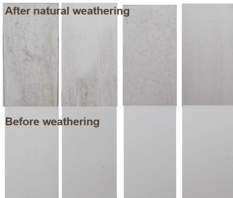
Figure 24 : Aspect de 4 peintures commerciales blanches avant (en bas) et après (en haut) 24 mois de vieillissement naturel (45°, Sud, Bordeaux) –Photographies FCBA©
