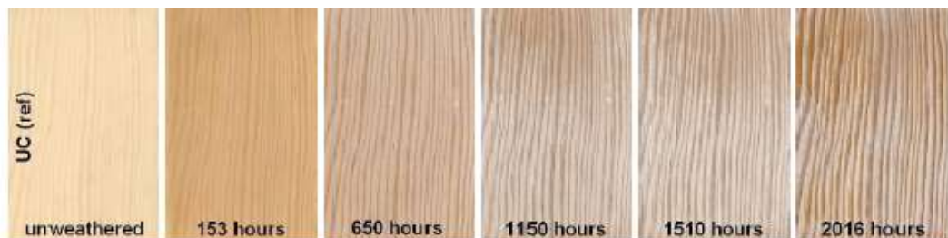
Figure 5 : Variations de couleur de pin sylvestre nu exposé dans un QUV durant 12 semaines (projet WoodWisdom-net WoodExter)
