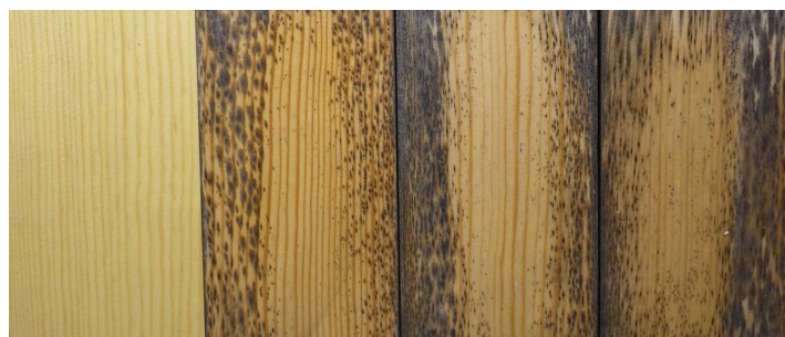
Figure 23 : : Aspect d'éprouvettes de pin sylvestre recouvert de 3 couches de lasure et exposées 12 mois à 45° face au nord (Bordeaux). A gauche : témoin non exposé ; à droite : trois répliques exposées. Photographies FCBA©
