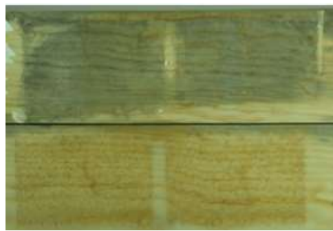
Aspect du pin sylvestre sous les films non adhérents (en haut : sous la peinture blanche ; en bas : sous la lasure marron)
