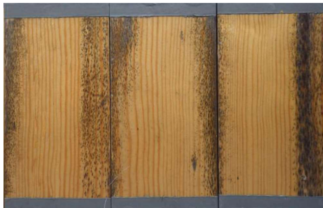
Figure 12 : développement de champignons de bleuissement sur 3 éprouvettes revêtues de lasure semi-transparente et dont les bois de bout sont imperméabilisés – Projet SERVOWOOD
