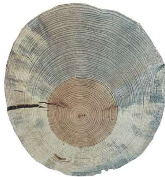
Figure 1 : section transversale de pin sylvestre dont l'aubier est bleu (Photo D. Dirol, CTBA) 4
