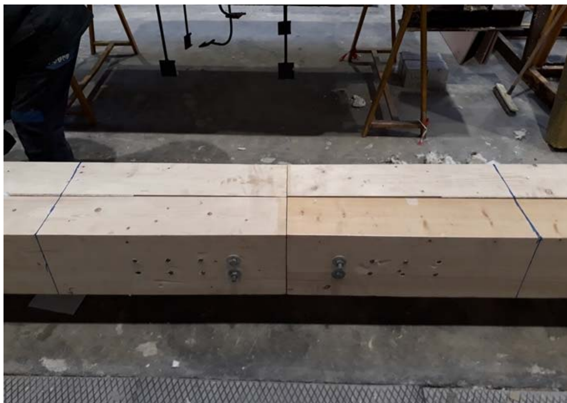
Figure A5.4 : Campagne 1 – Configuration 2 – Assemblage avant essai
