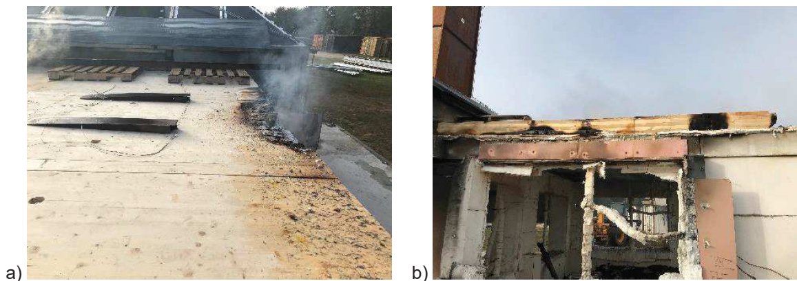
Figure E-46 : Vues extérieures des percements le lendemain de l'Essai 4 a) interface plafond/paroi côté Ouest ; b) interface plafond/paroi côté Est
