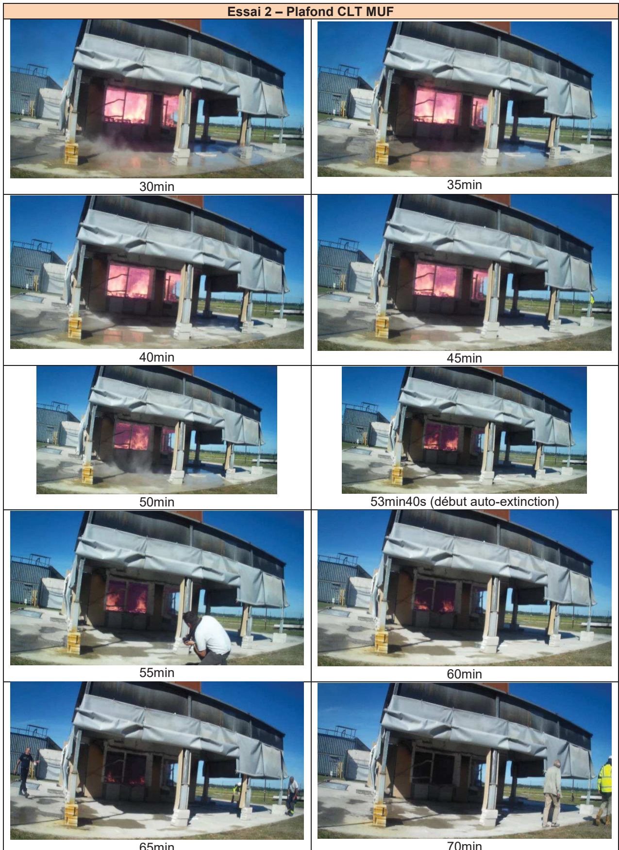
Figure 5-3 : Prises de vue depuis la caméra Sud-Ouest lors de l'Essai 2 sur 70minutes
