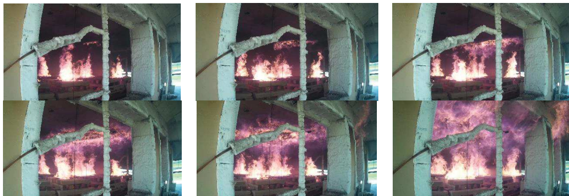
Figure 7-4 : Détails de l'inflammation du plafond CLT PU lors de l'Essai 4 sur 30secondes
