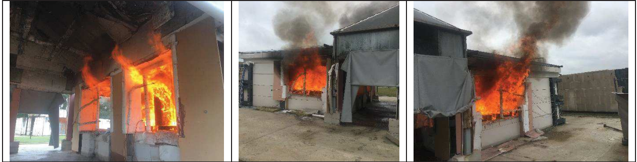
Figure 6-5 : Sorties de flammes aux ouvertures a) Sud ; b) Ouest et c) Est lors de l'Essai 3
