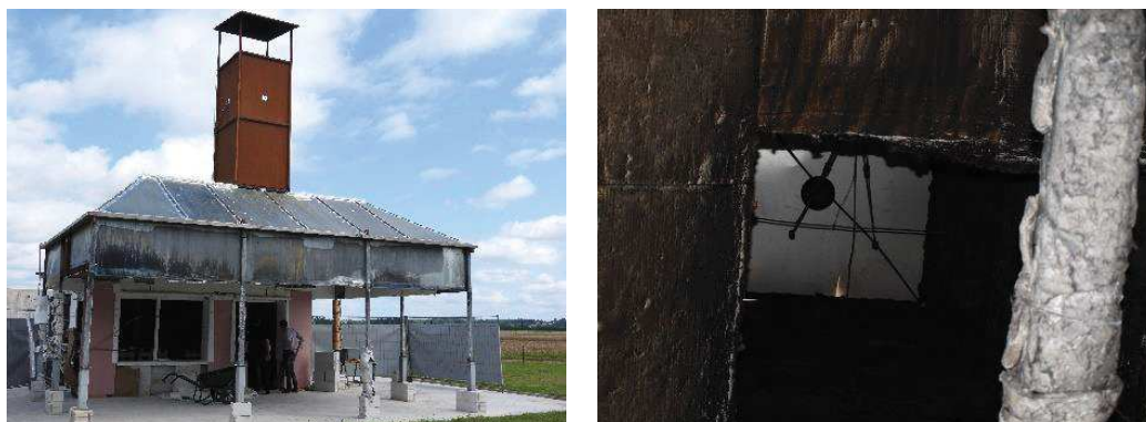
Figure 2-24 : Hotte calorifique au Sud de la cellule d'essais et visualisation des points de mesures dans la cheminée
