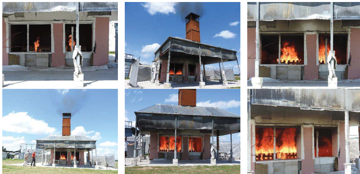
Figure 3-3 : Phase de démarrage et de développement de l'incendie (Essai 0) 0 à 10min
