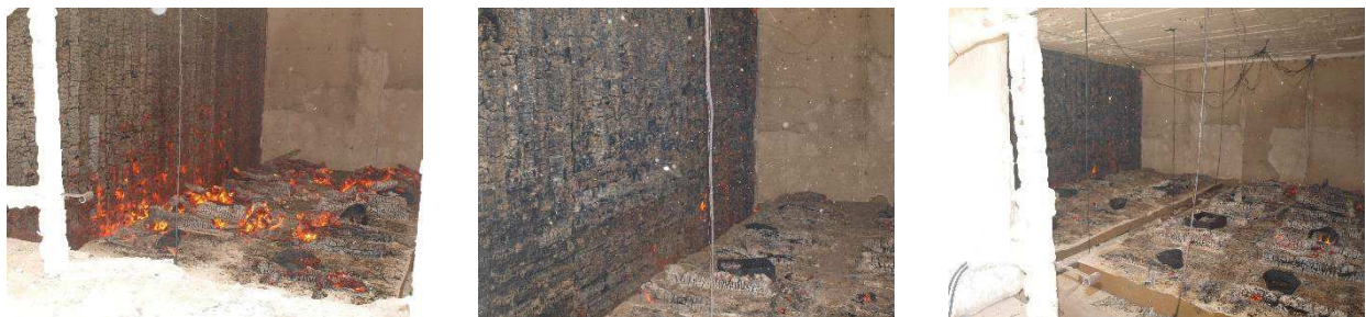
Figure 4-5 : Fin de l'Essai 1 (fin de combustion des bûchers et auto-extinction de la paroi CLT MUF)
