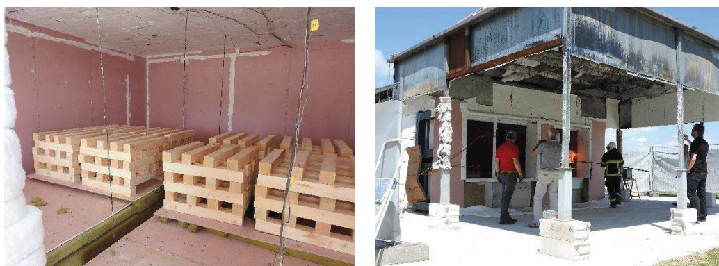
Figure 3-2 : Bûchers mis en place pour l'essai 0 et allumage des bacs d'heptane par boutefeu
