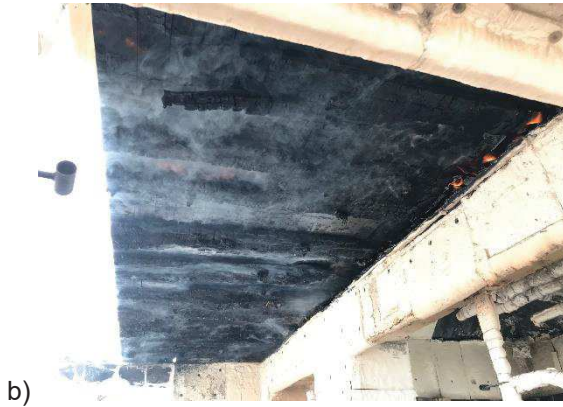
Figure E-47 : État de la sous-face du plafond CLT le lendemain de l'Essai 4 a) panneau central ; b) panneau Sud ; c) panneau Nord
