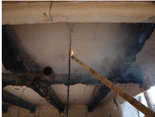
Figure 10-41 : Non inflammation des gaz sous plafond le soir de l'essai 3 ( t_{fin}+3h )
