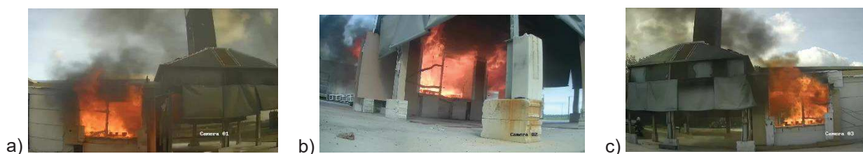
Figure 7-5 : Sorties de flammes aux ouvertures a) Ouest, b) Sud et c) Est lors de l'Essai 4
