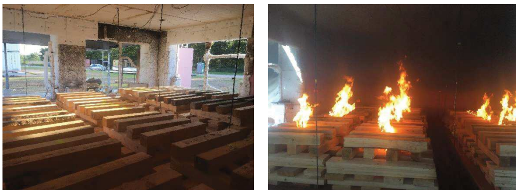
Figure 7-2 : Bûchers pour l'essai 4 et repérage des départs de feu
