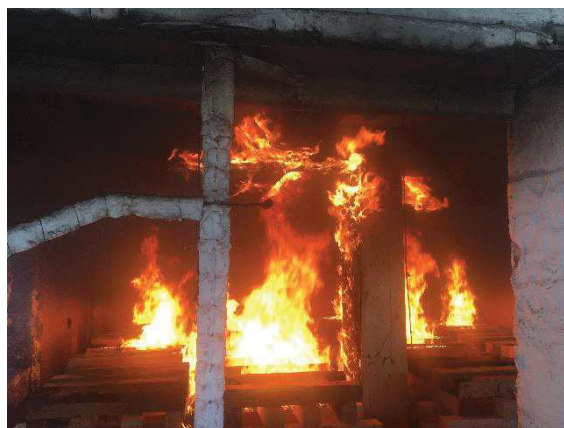
Figure 6-4 : Détail de l'inflammation du poteau et entretoise lors de l'Essai 3
