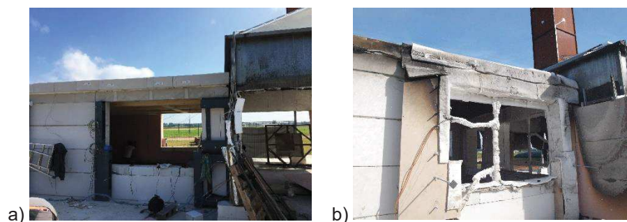
Figure 2-13 : Prises de vue de la baie Ouest avant et après protection (Essai 2)
