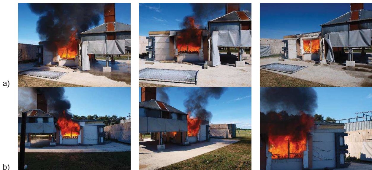
Figure 5-6 : Sorties des flammes aux ouvertures a) Ouest et b) Est lors de l'Essai 2
