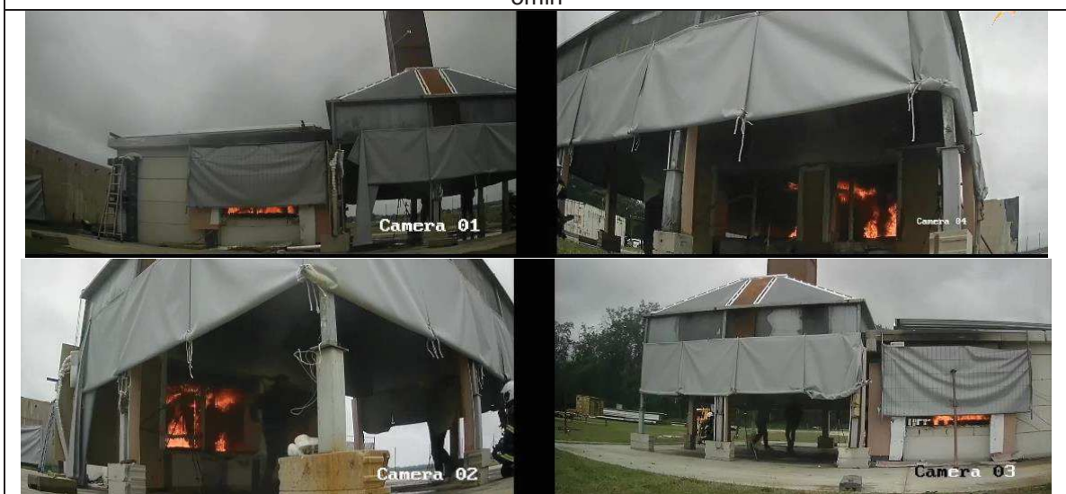
7,5min (inflammation du poteau et poutres BLC)
