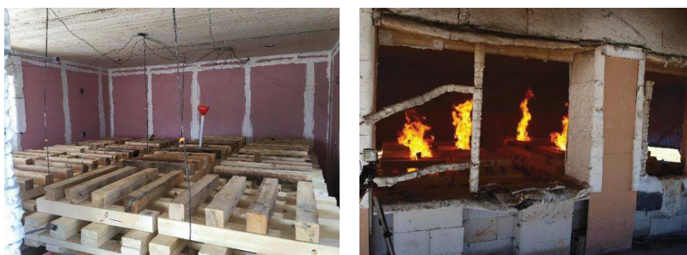
Figure 5-2 : Bûchers pour l'essai 2 et repérage des départs de feu
