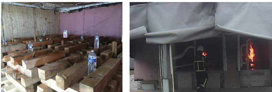
Figure 4-2 : Bûchers pour l'essai 1 avec repérage des bacs d'heptane et allumage au boutefeu
