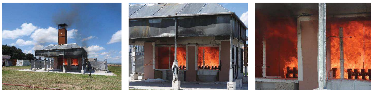
Figure 3-4 : Phase d'incendie pleinement développé (Essai 0) 10 à 20min
