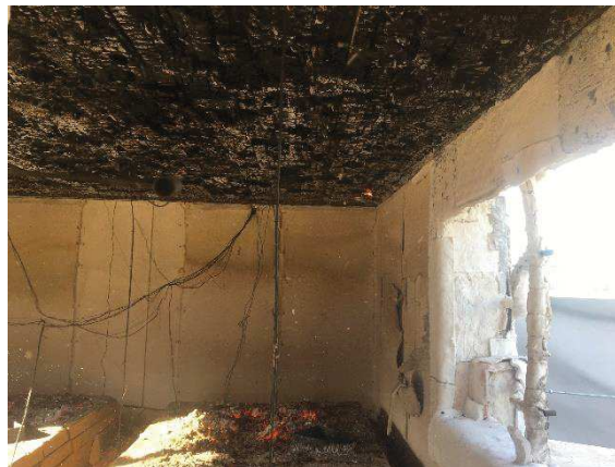
Figure 7-7 : Fin de l'Essai 4 (fin de combustion des bûchers et auto-extinction du plafond CLT PU)
