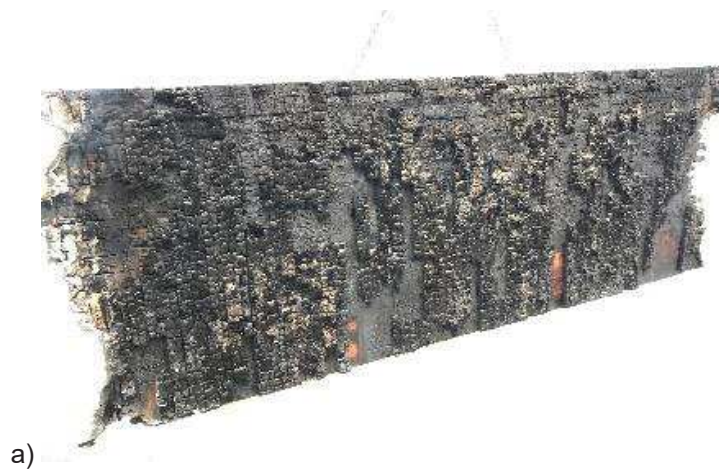
Figure E-46 : Vues extérieures des percements le lendemain de l'Essai 4 a) interface plafond/paroi côté Ouest ; b) interface plafond/paroi côté Est
