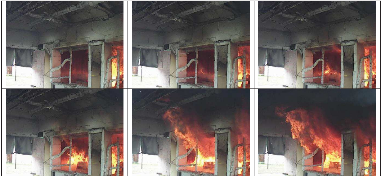
Figure 4-4 : Détails de l'inflammation de la paroi CLT MUF lors de l'Essai 1 sur 30secondes
