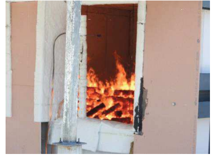
Figure 3-6 : Phase d'extinction de l'incendie (Essai 0) 20 à 50min
