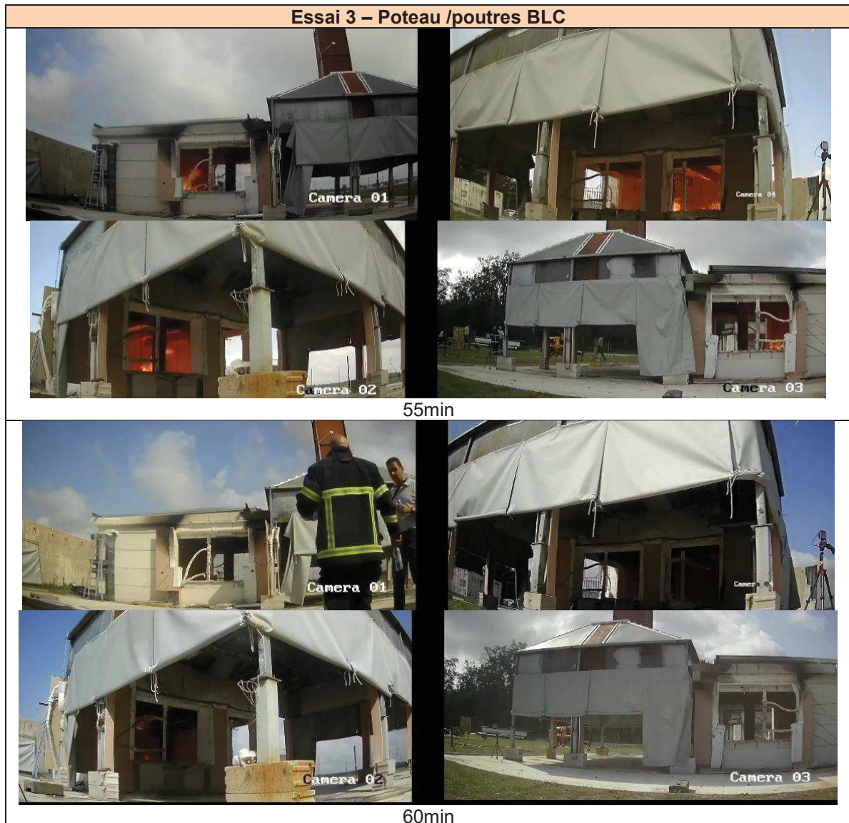
Figure 6-3 : Prises de vue depuis les caméras fixes lors de l'Essai 3 sur 60minutes
