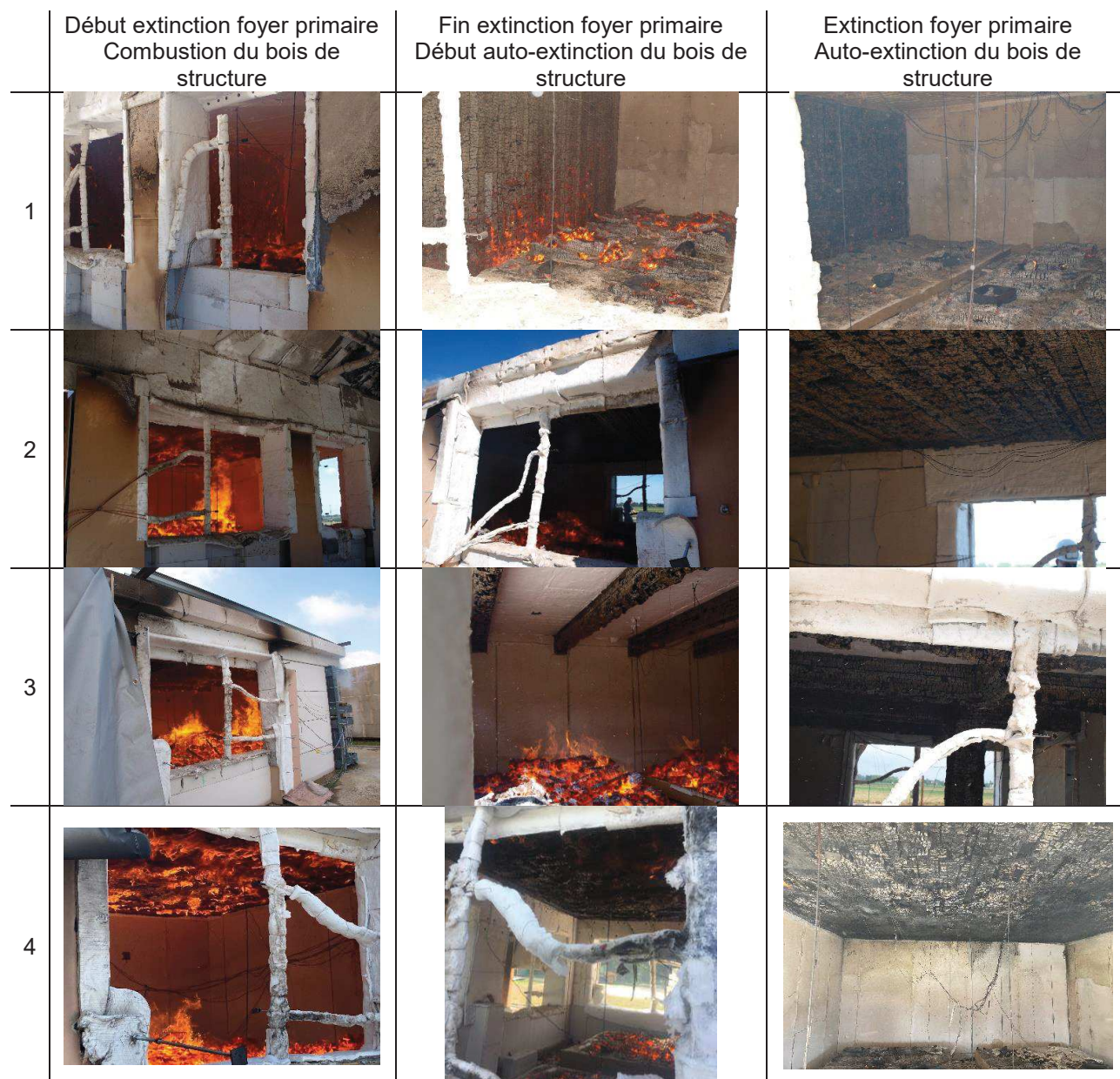
Figure 8-4 : Illustrations du phénomène d'auto-extinction du bois de structure pour les essais 1 à 4
