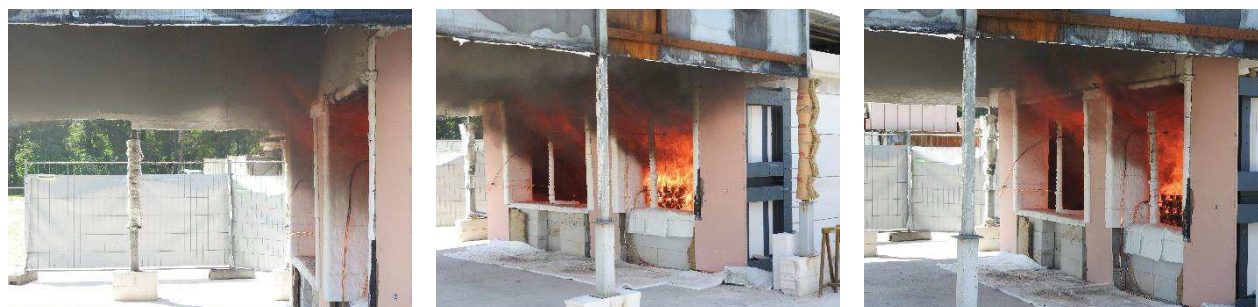
Figure 3-5 : Flammes extérieures sortant par les ouvertures Sud (Essai 0) 10 à 15min
