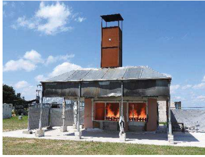
Figure 3-6 : Phase d'extinction de l'incendie (Essai 0) 20 à 50min
