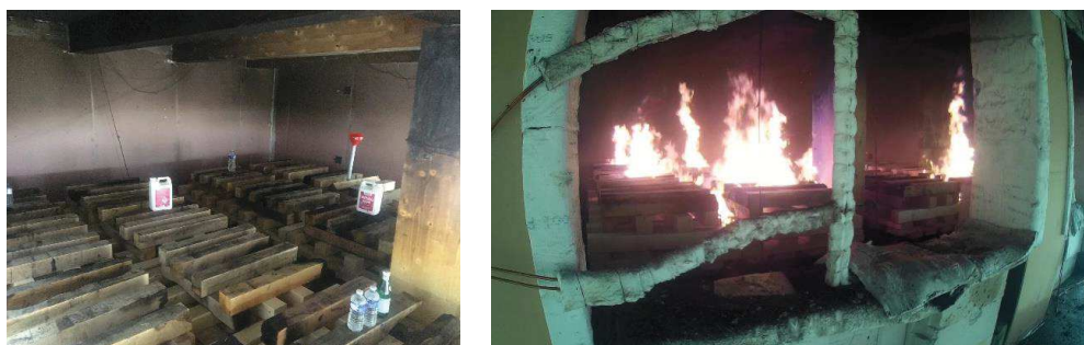
Figure 6-2 : Bûchers pour l'essai 3 et repérage des départs de feu
