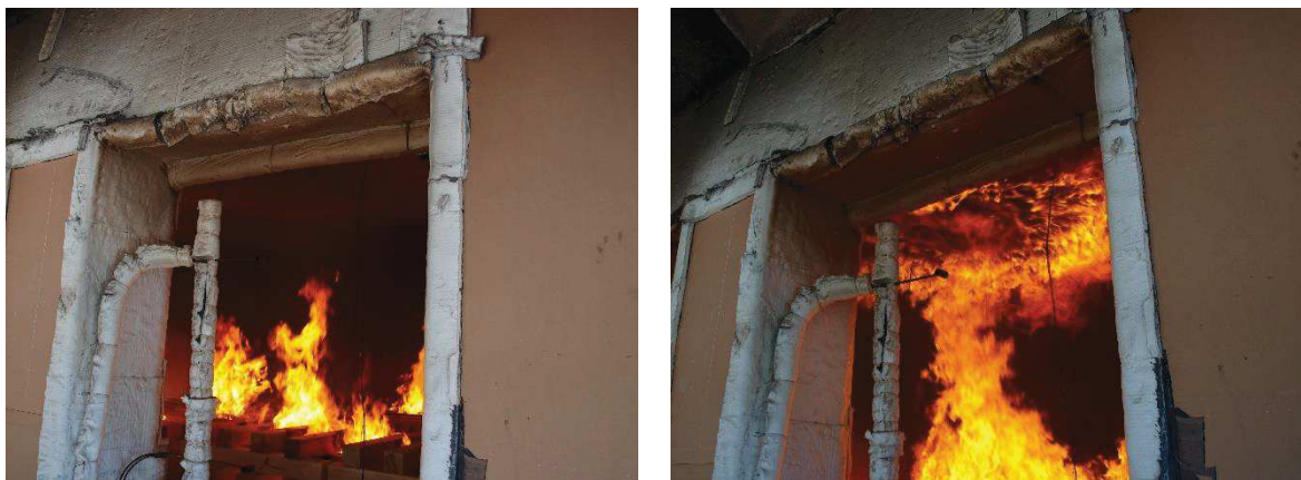
Figure 5-5 : Détails de l'inflammation du plafond CLT MUF lors de l'Essai 2
