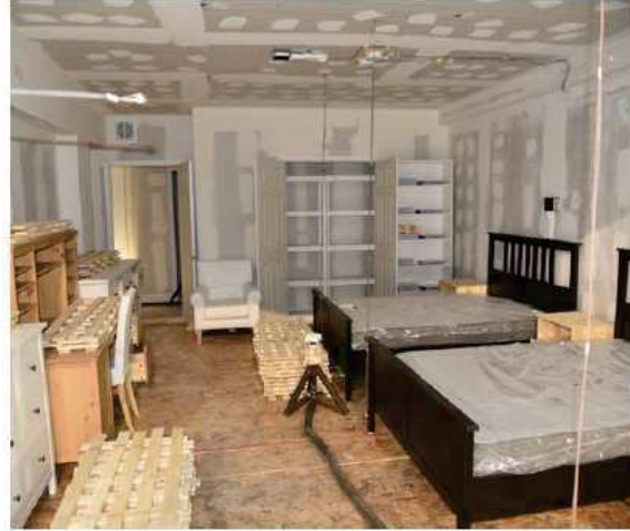
Illustration de la charge combustible dans le living-room et dans la chambre lors des essais de Zelinka et al.
