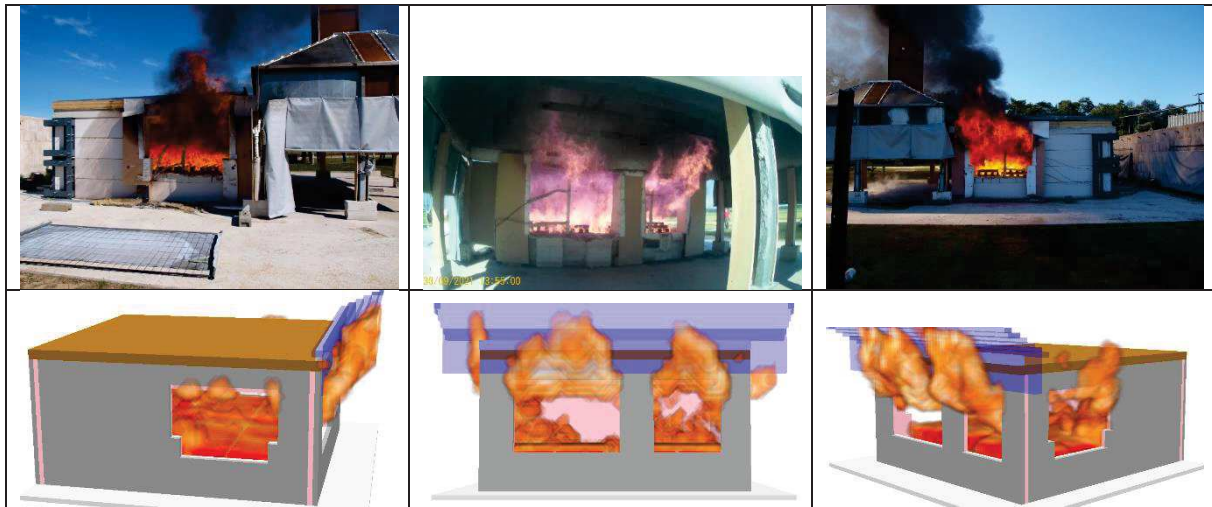
Figure A-5 : Comparaison qualitative de la libération d'énergie/flammes aux ouvertures pour différents instants de l'Essai 2 entre prises de vue et calcul
