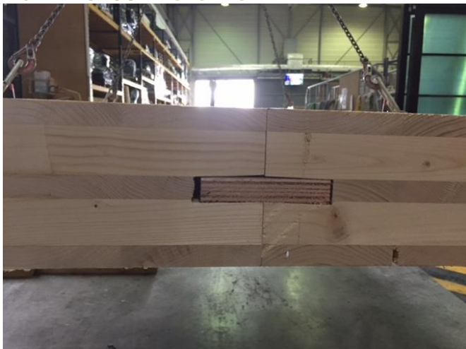
Assemblage des deux modules du plancher (Essais 3 à 8)
