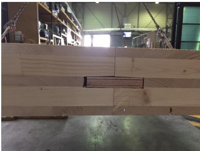
Assemblage des deux modules du plancher
