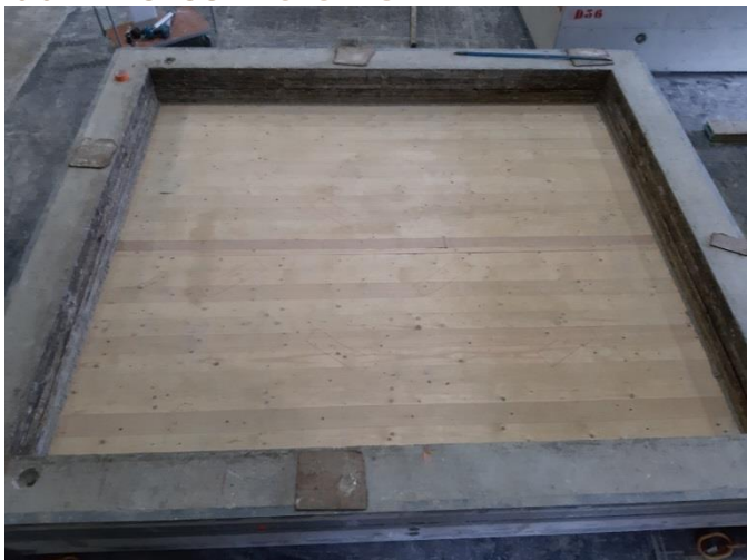
Plancher support (Essais 9 à 11)
