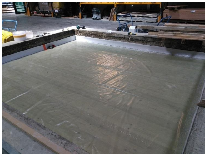
Polyane posé sur le plancher (Essais 3 à 8)
