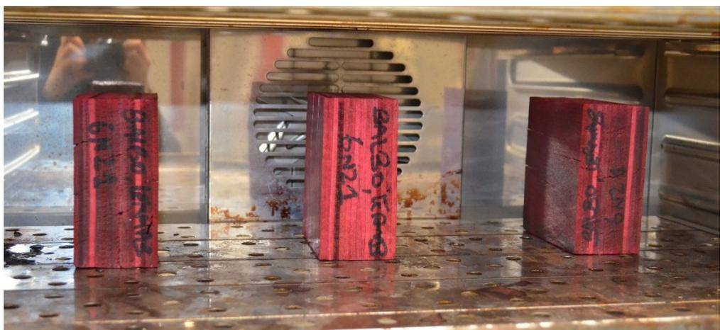
Figure A 2.7 Epreuves dans l'étuve après 15 heures de séchage à 65°C
