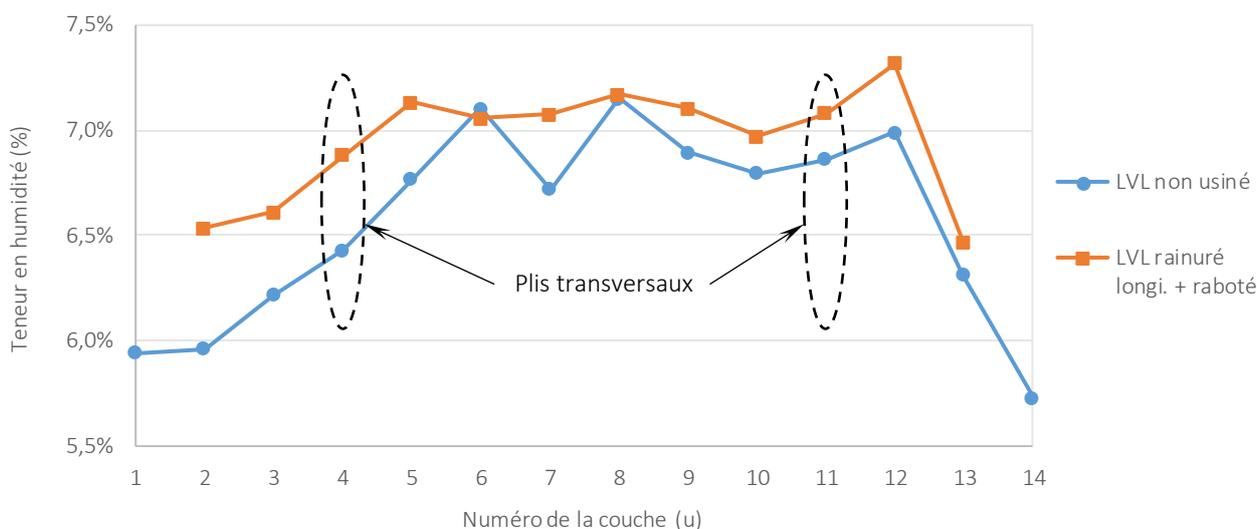
Figure A 2.3 Evolution de la teneur en humidité des couches du LVL avant et après usinages
