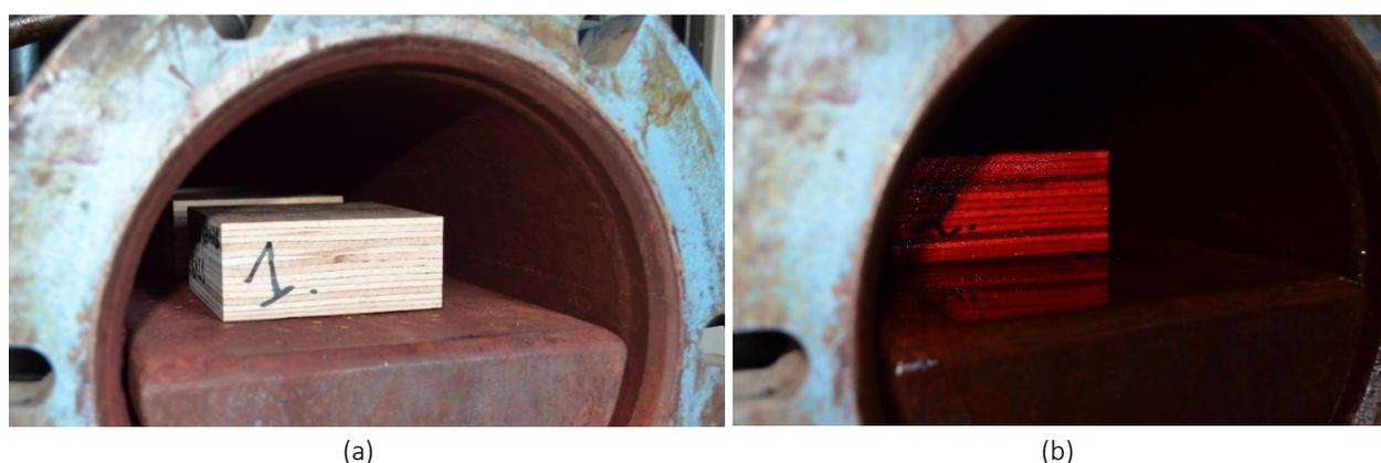
Figure A 2.5 Eprouvettes 1, 2 et 3 dans à l'autoclave avant le cycle dépression-pression (a) et après (b)
