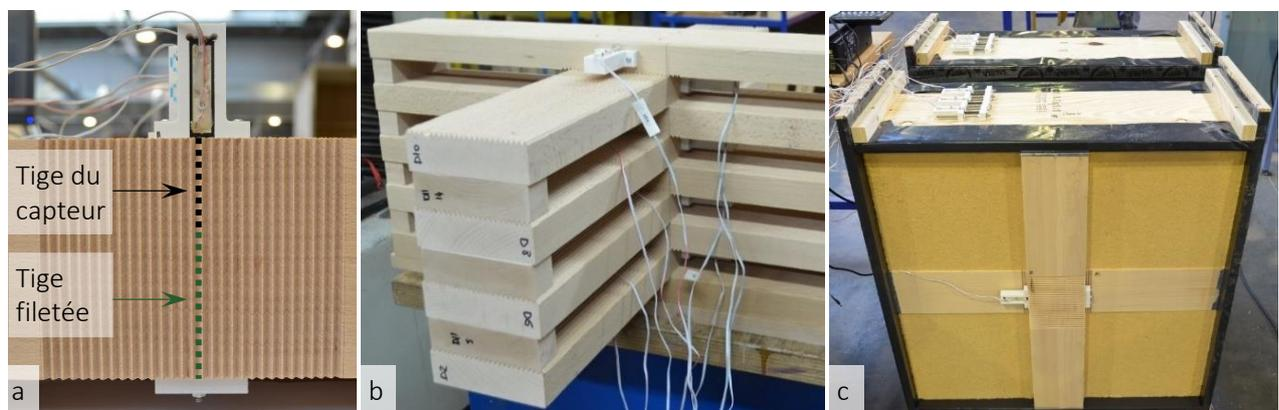
Figure 3-1 Photos des essais hygrothermique : (a) mesure avec capteur de déplacement (tige du capteur et tige filetée en contact dans un perçage effectué sur la hauteur de la planche), (b) assemblage rainuré avec 9 planches en hêtre instrumenté et (c) modules d'essais en cours de montage
